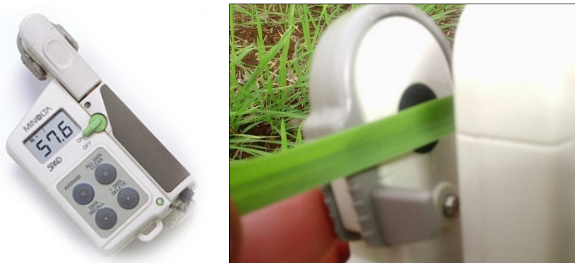
Figura 21 – Clorofilômetro digital utilizado nas avaliações de clorofila no trigo e GPS de navegação para localização de pontos georeferenciados.
