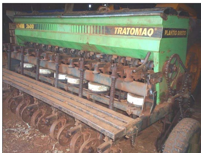
Figura 53 – Semeadora hidrlica Tratomac TMH 2600 – Plantio Direto, montada para soja. Cerro largo, 2005.
