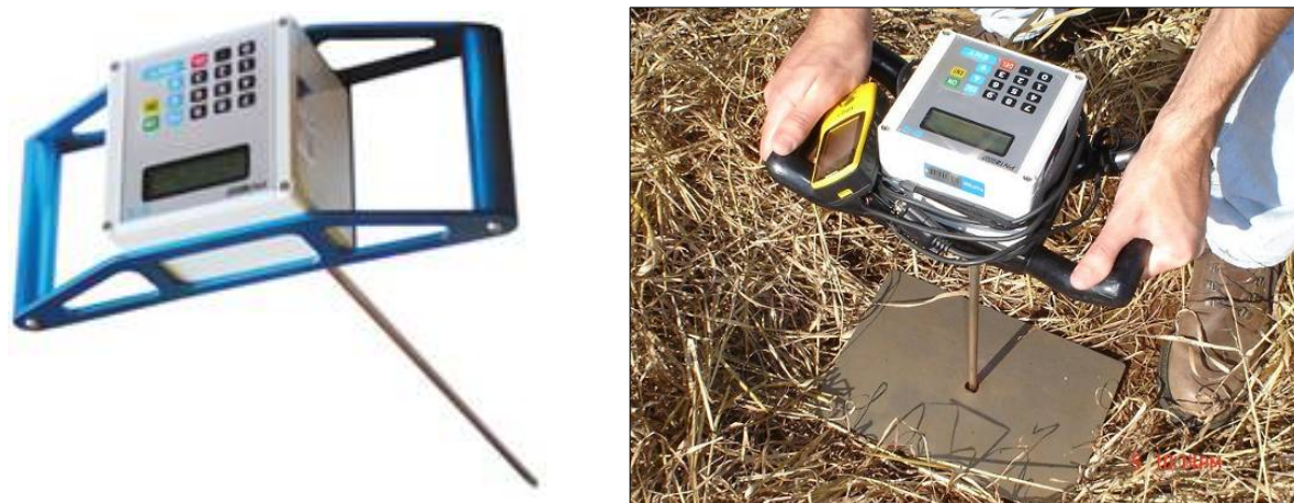
Figura 19 – Penetrômetro digital georeferenciado DLG modelo PNT-2000 e operação de penetrometria a campo.
