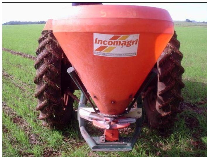
Figura 54 – Distribuidor centrífugo monodisco Incomagri acoplado no trator pelo sistema hidrulico de 3 pontos. Cerro Largo – RS, 2005.
