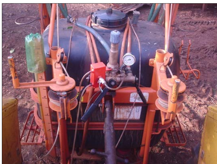
Figura 55 – Pulverizador de barras Jacto 600L com 12 metros de barra e com sistema de marcador de espuma. Cerro Largo – RS, 2005.
