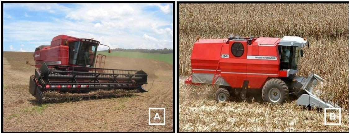
**Figura 4** – Colhedora CASE 2388, equipada com Sistema AFS<sup>®</sup> (A), e colhedora Massey Ferguson, modelo MF 34 equipada com o Sistema Fieldstar<sup>®</sup> (B).
