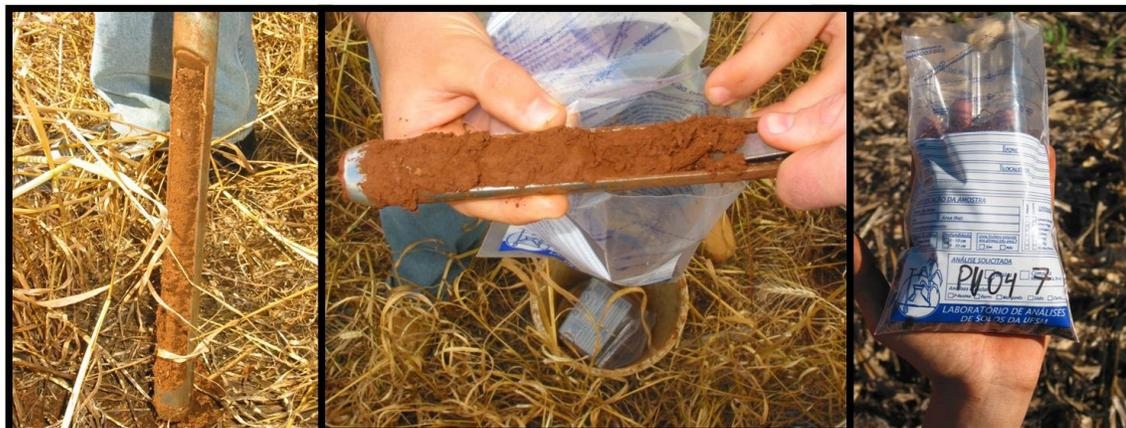
**Figura 6** – Detalhe da coleta das amostras de solo nos pontos georeferenciados, na profundidade de 0 a 0,1 m para as duas as áreas em estudo.
