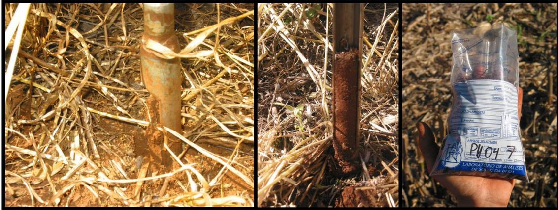
**Figura 6** – Detalhe da coleta das amostras de solo nos pontos georeferenciados, na profundidade de 0 a 0,1 m para as duas áreas em estudo.
