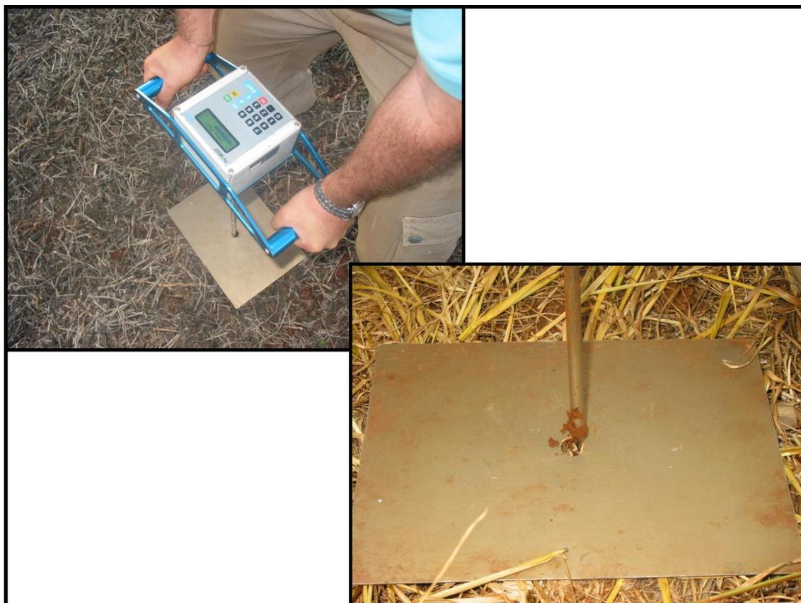
**ANEXO B** – Detalhes do Cornell Sprinkle Infiltrometer utilizado na determinação da infiltração e escoamento superficial de água, para as três zonas de rendimento estudadas, nas áreas experimentais de Trindade do Sul, RS e em Palmeira das Missões, RS.
