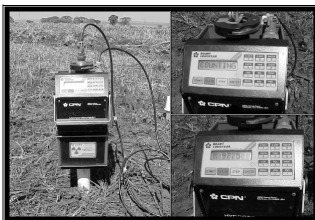
Figura 2.9 – Sonda de Nêutrons (Ferreira 2003).
