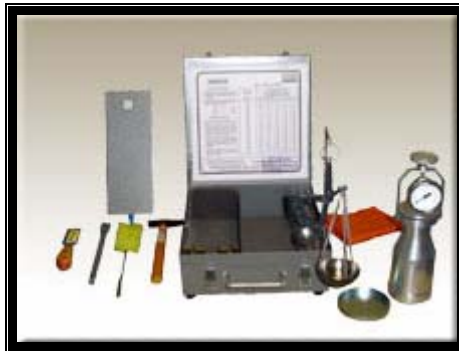
Figura 2.8 - Equipamentos utilizados no método Speedy (viatest)
