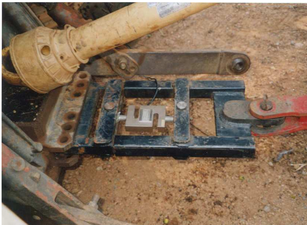
Figura 11 - Estrutura com a célula de carga montada a barra de tração do trator. (GARCIA et al., 2003).
