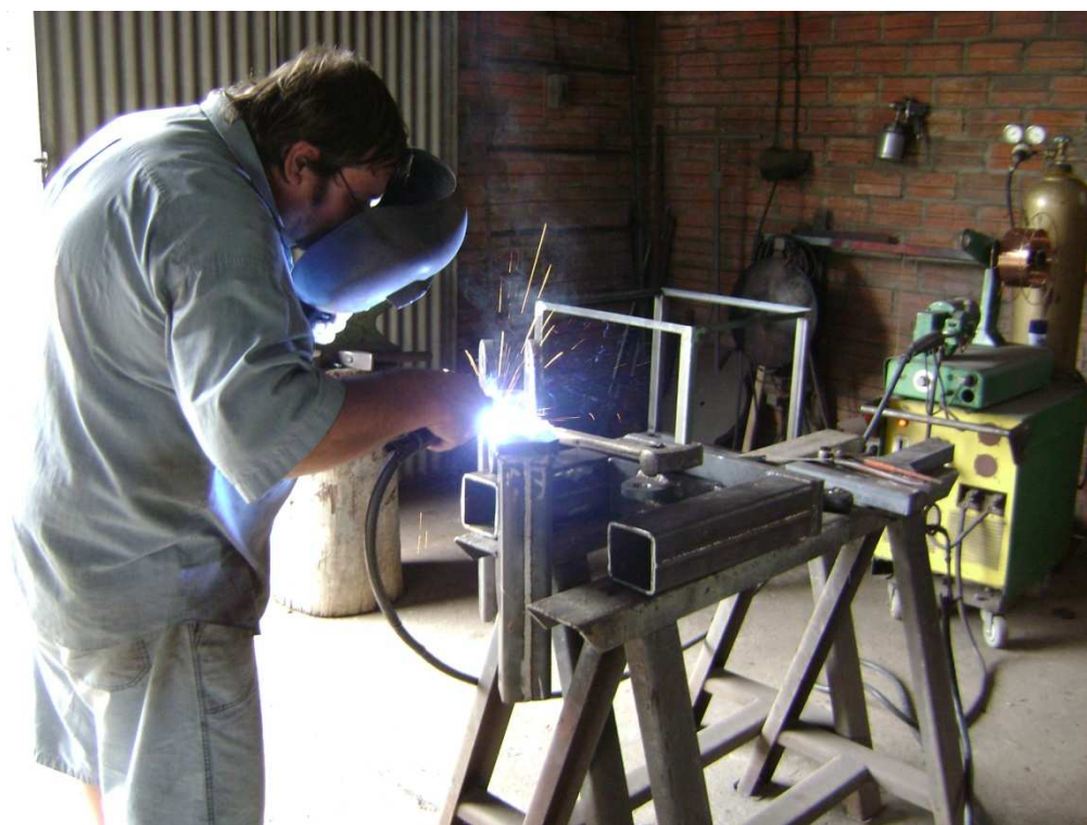
Figura 53 – Construção da barra de tração.
