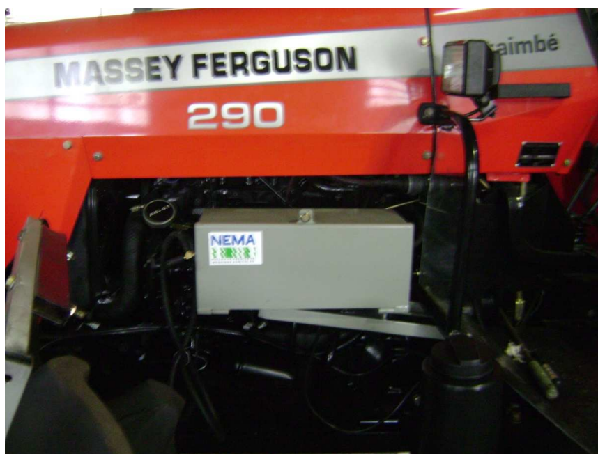
Figura 60 – Vista externa da caixa de acondicionamento do fluxômetro.
