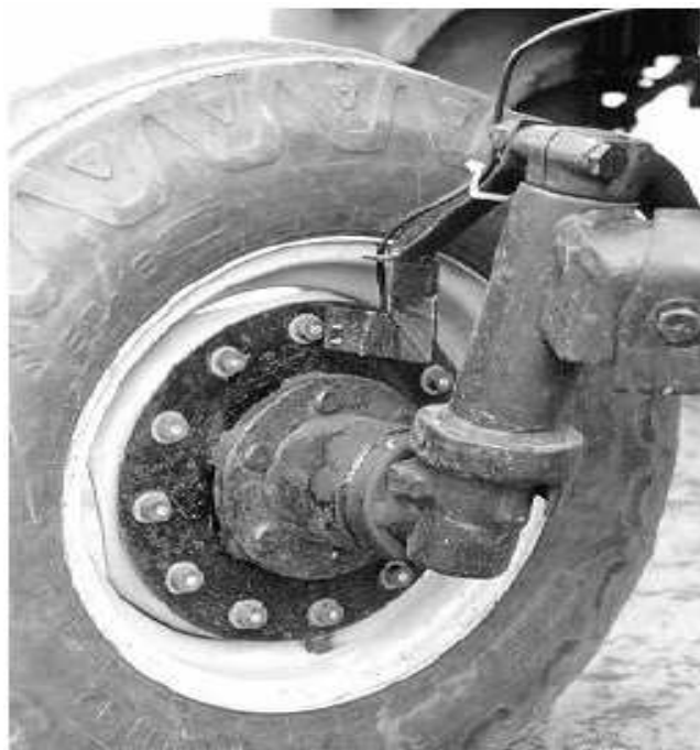
Figura 8 - Flange com ímãs preso ao cubo da roda dianteira do trator (ANTUNIASSI et al., 2001).
