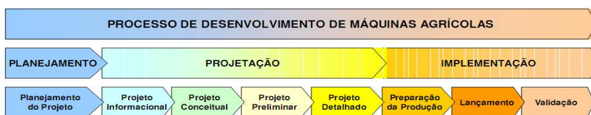
Figura 12 – Processo de desenvolvimento de máquinas agrícolas (ROMANO, 2003).
