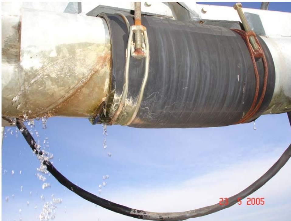
Figura 4 – Conjunto mangote de união de lance do equipamento de irrigação por pivô central
