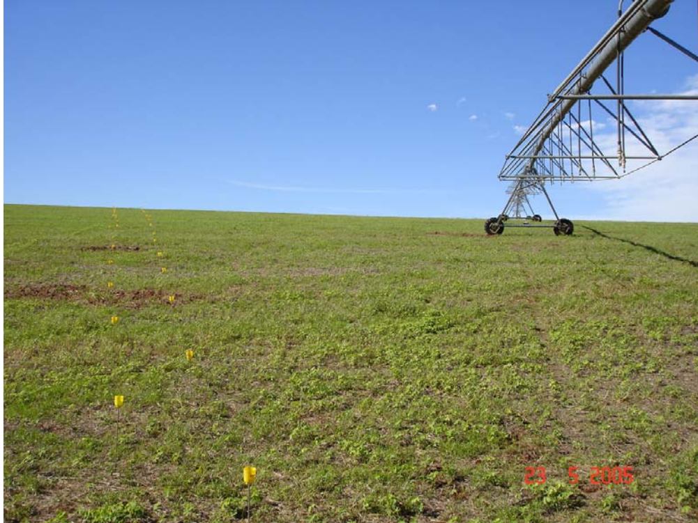
Figura 1 – Disposição dos coletores de água em área irrigada por pivô central, na realização do teste de uniformidade
