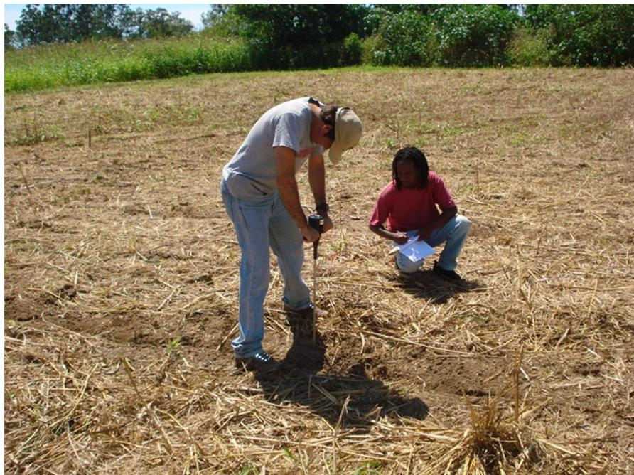
**Figura 3 – Levantamento dos dados da resistência do solo à penetração.**
