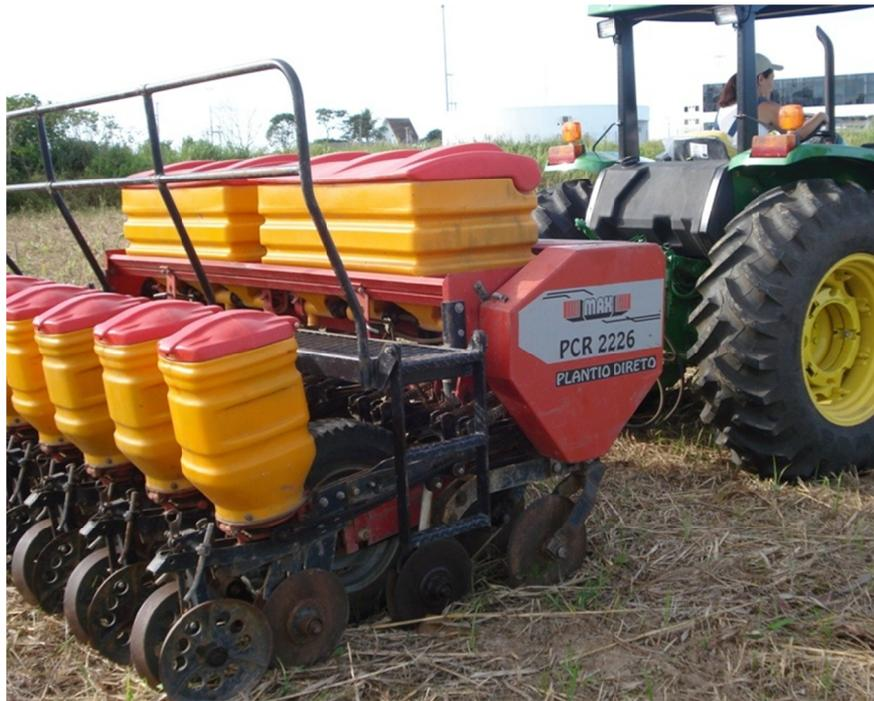
**Figura 6 – Semeadora-adubadora Seed-Max PCR 2226 utilizada no experimento.**
