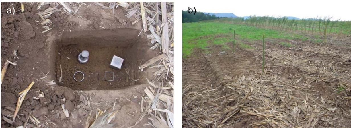
Figura 24 - Detalhe da coleta das amostras de compressibilidade e de cisalhamento (a), e do aspecto da área após o tráfego (b).
