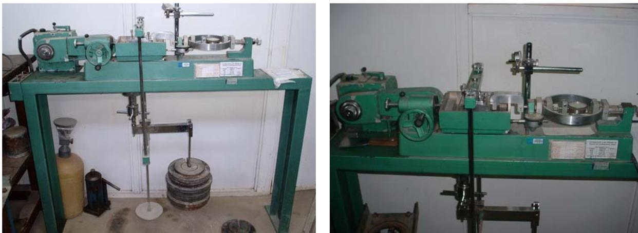
Figura 30 – Prensa de cisalhamento direto do laboratório de Mecânica do Solo.
