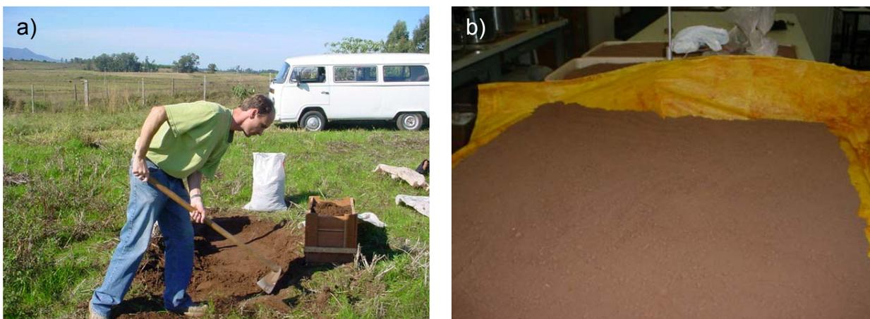
Figura 27 – Coleta do solo a campo profundidade de 0 a 10 cm (a) e secagem do solo ao ar para a realização do ensaio de Proctor (b).
