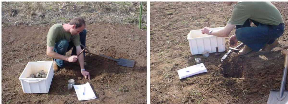
Figura 21 – Coleta das amostras de compressibilidade e densidade antes da escarificação.
