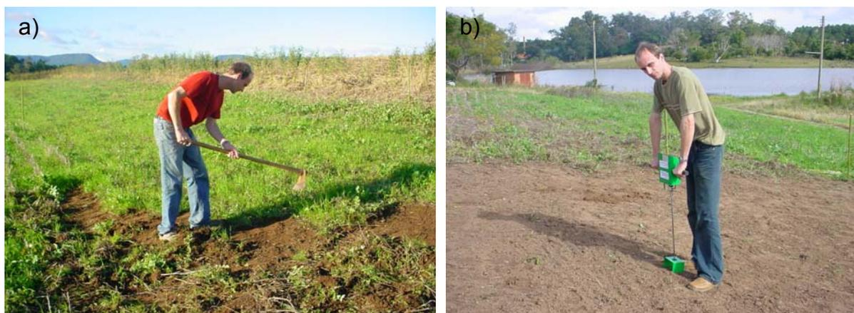
Figura 20 - Limpeza da área para ensaio (a), e resistência à penetração na área, no rastro e deixado pela colhedora e fora dele (b).
