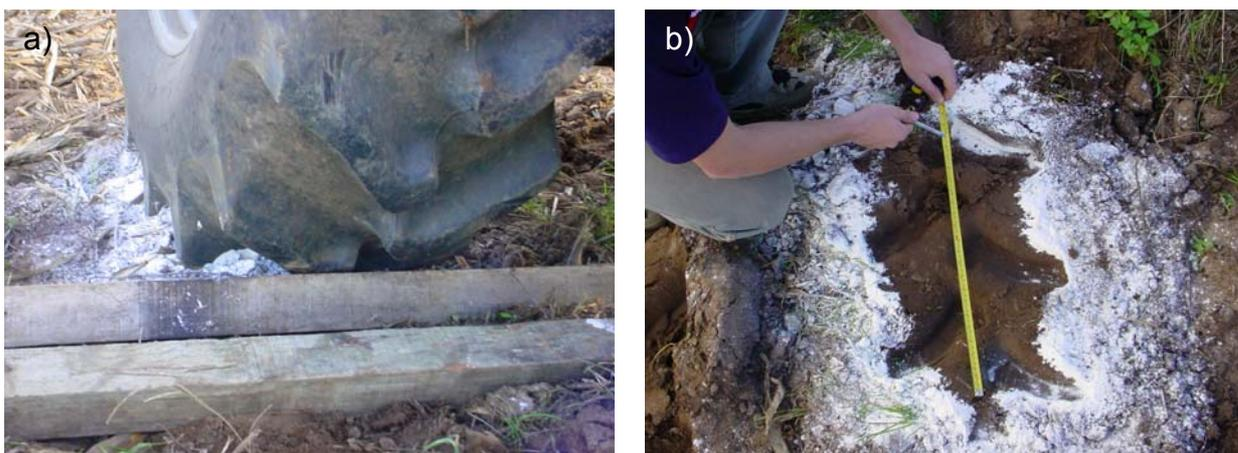
Figura 25 – Determinação da área de contato pneu-solo, detalhe do pneu traseiro e das tábuas (a), e a área de contato demarcada no solo e medição do pneu dianteiro (b).
