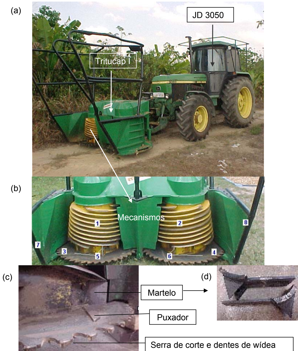
Figura 5 – Tritucap- Protótipo de triturador de capoeira, com respectivas especificações. (a) conjunto trator e triturador, (b) mecanismos trituradores, (c) mecanismos em detalhe e (d) martelos.
