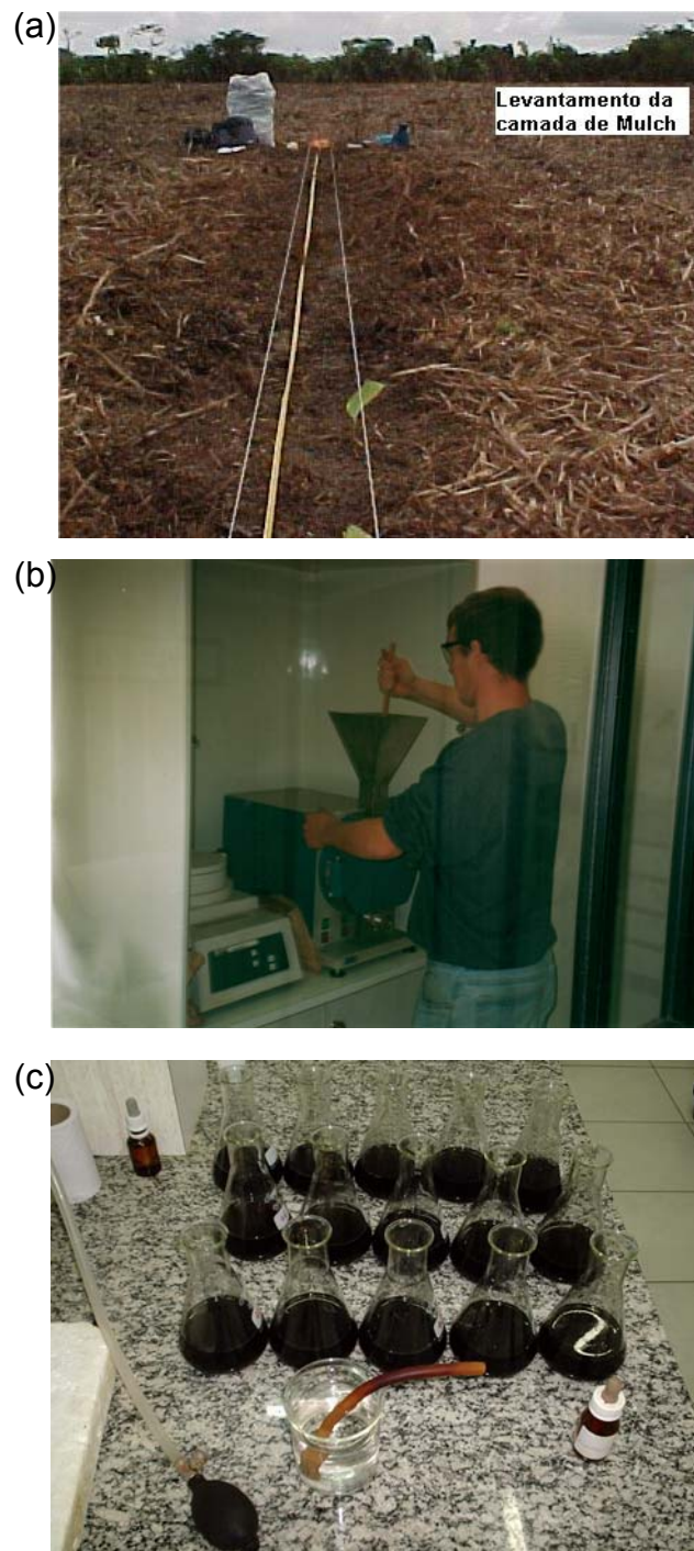
Anexo 3 – Mensuração da espessura de deposição do material pós-trituração (a). Detalhe do preparo das amostras em laboratório: Moagem (b) e determinação de carbono (c).
