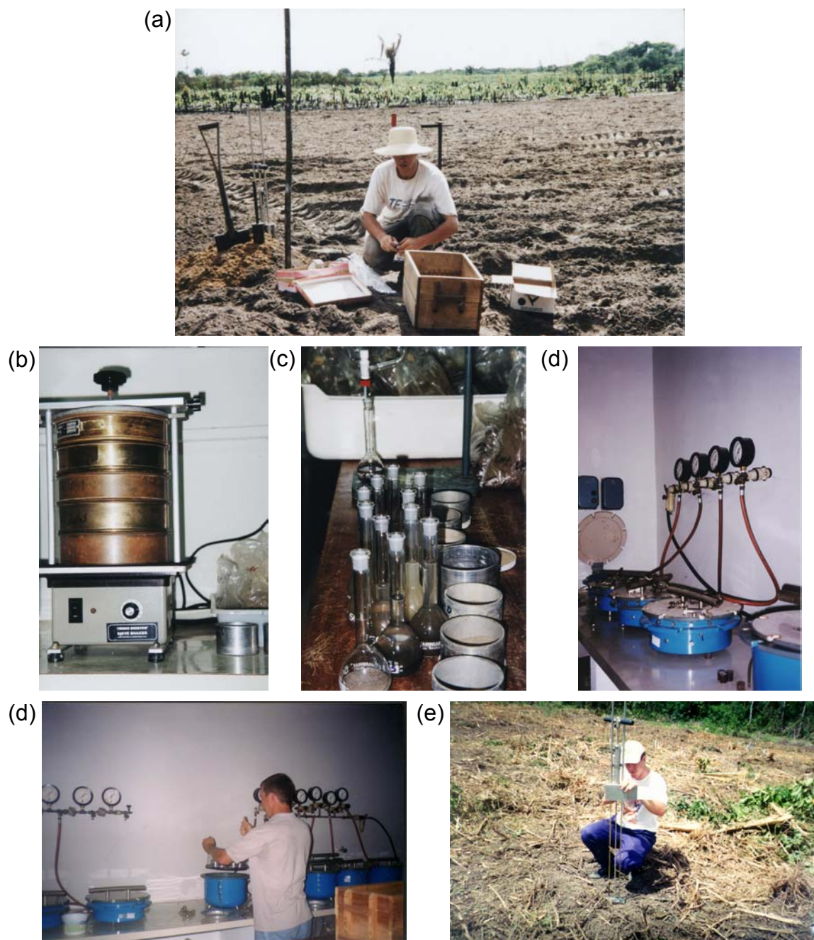
Anexo 6 – Detalhe da coleta de amostras nos tratamentos e determinação da resistência à penetração a campo (a, e) (Estudo 2). Aparelho de peneiramento a seco para determinação do DMG (b), determinação da densidade de partícula (c), Extratores de Richards para amostras preservadas submetidas a baixas pressões e amostras desestruturadas à pressão de 1500 kPa (Laboratório de Física do solo. Embrapa Amazônia Oriental) (d).
