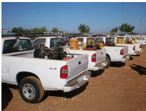
Figura 9 - Equipamentos nebulizadores alocados sobre caminhonetes, popularmente conhecido como “UBV pesado”
