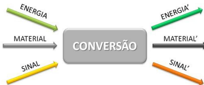
Figura 26 – Conversão de energia, material e sinal de um sistema técnico complexo. Fonte: adaptado de Pahl et alii (2005).
