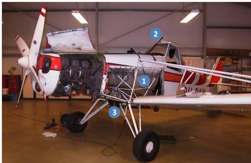
Figura 2 – Aeronave agrícola em manutenção. 1- Reservatório de produtos; 2- Sistema corta-fio para segurança do piloto em caso de vôos sob rede elétrica; 3-tubulação de saída do produto químico para aplicação.
