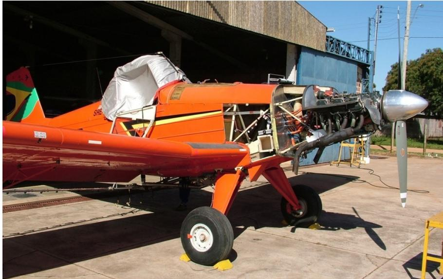
Figura 9 – Aeronave Ipanema EMB202 em manutenção, detalhe do motor Lycoming de 224kW.
