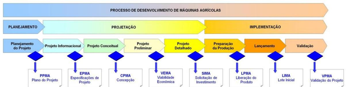
Figura 30 - Estrutura básica do MR-PDMA com as fases e suas respectivas saídas.
