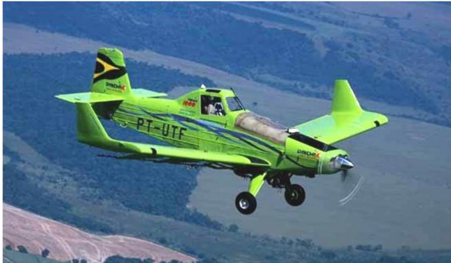
Figura 4 - Aeronave EMB-202A – Ipanemão a álcool.
