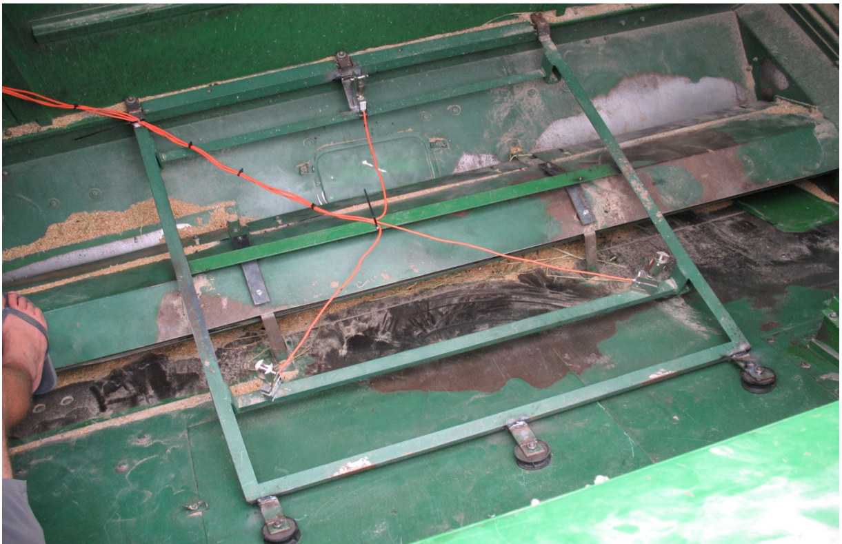
Figura 19 – Estrutura base da balança eletrônica e as 3 células de carga montadas em paralelo.
