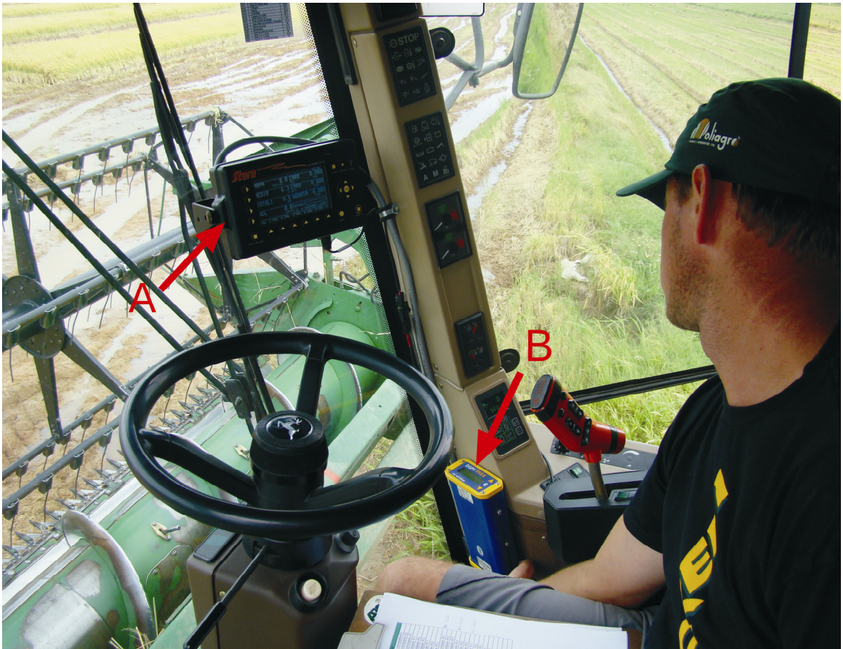
Figura 15 - Interior da cabine da colhedora, terminal de operação (A) e receptor GPS do monitor de produtividade (B).
