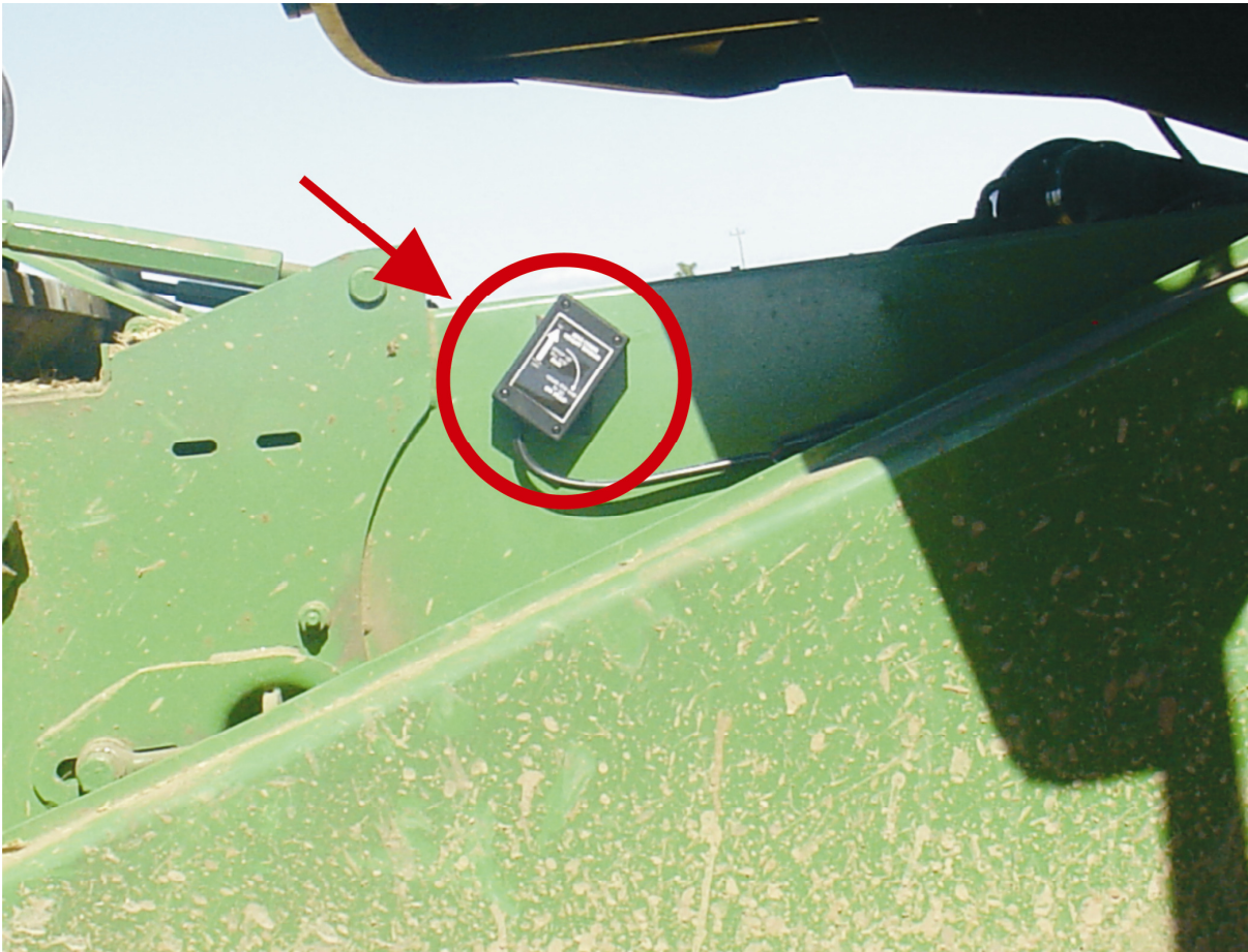
Figura 14 - Sensor interruptor da plataforma instalado lateralmente ao condutor longitudinal da colhedora.
