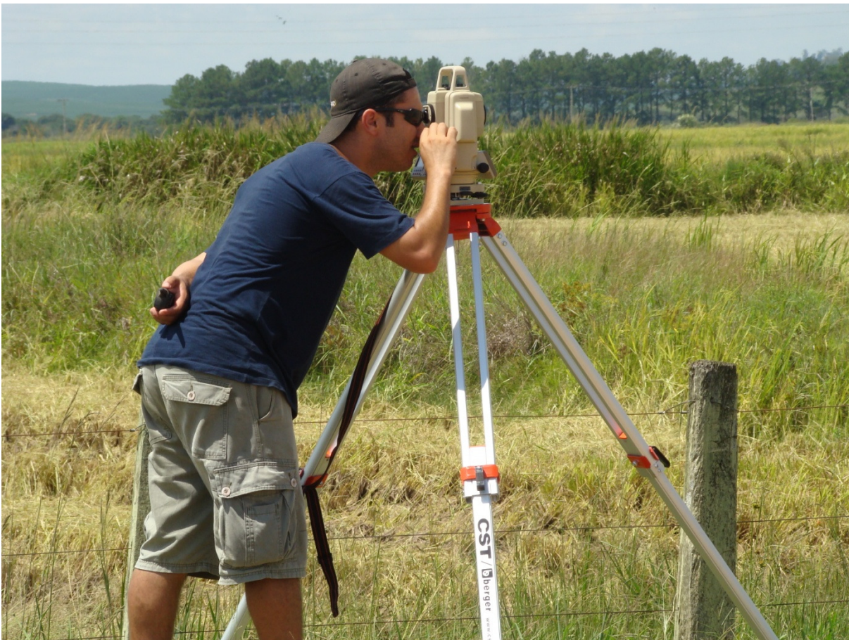
Figura 4 - Estação total Kolida KTS-442L utilizada na alocação dos pontos para demarcação das parcelas.
