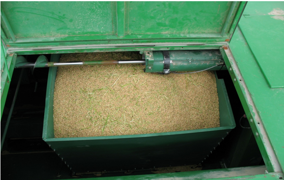
Figura 21 - Balança eletrônica instalada no reservatório de grãos da colhedora para servir como referência na avaliação do monitor de produtividade.
