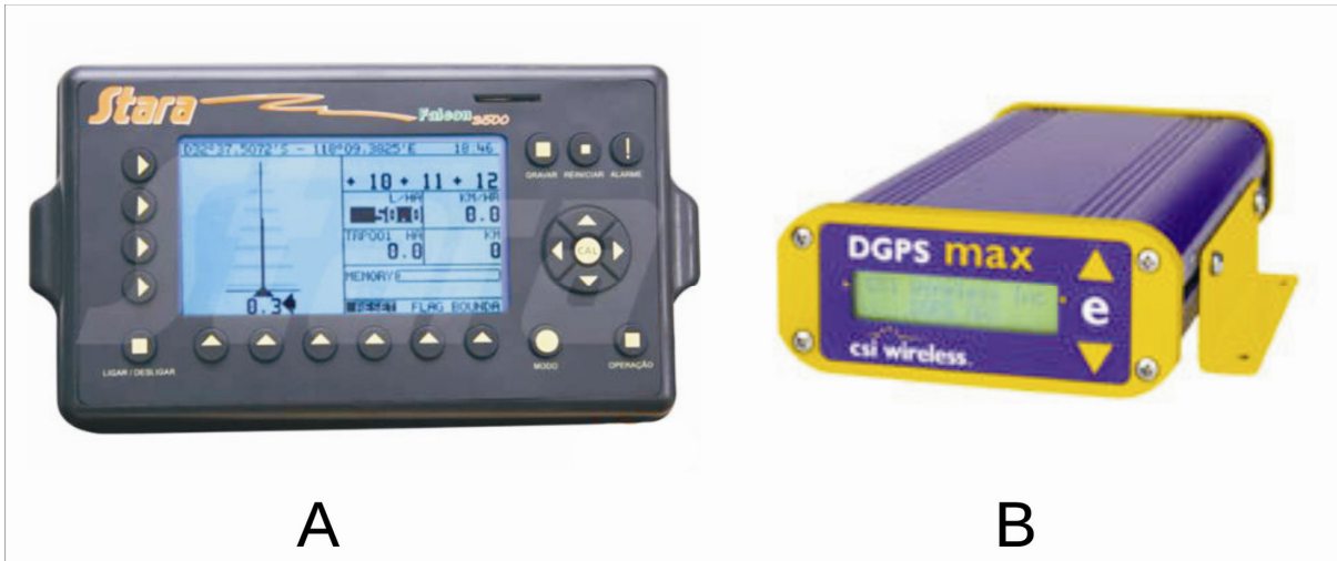
Figura 16 – Detalhe dos terminais Falcon 3500® (A) e receptor GPS DGPS MAX (B), componentes do monitor de produtividade avaliado.
