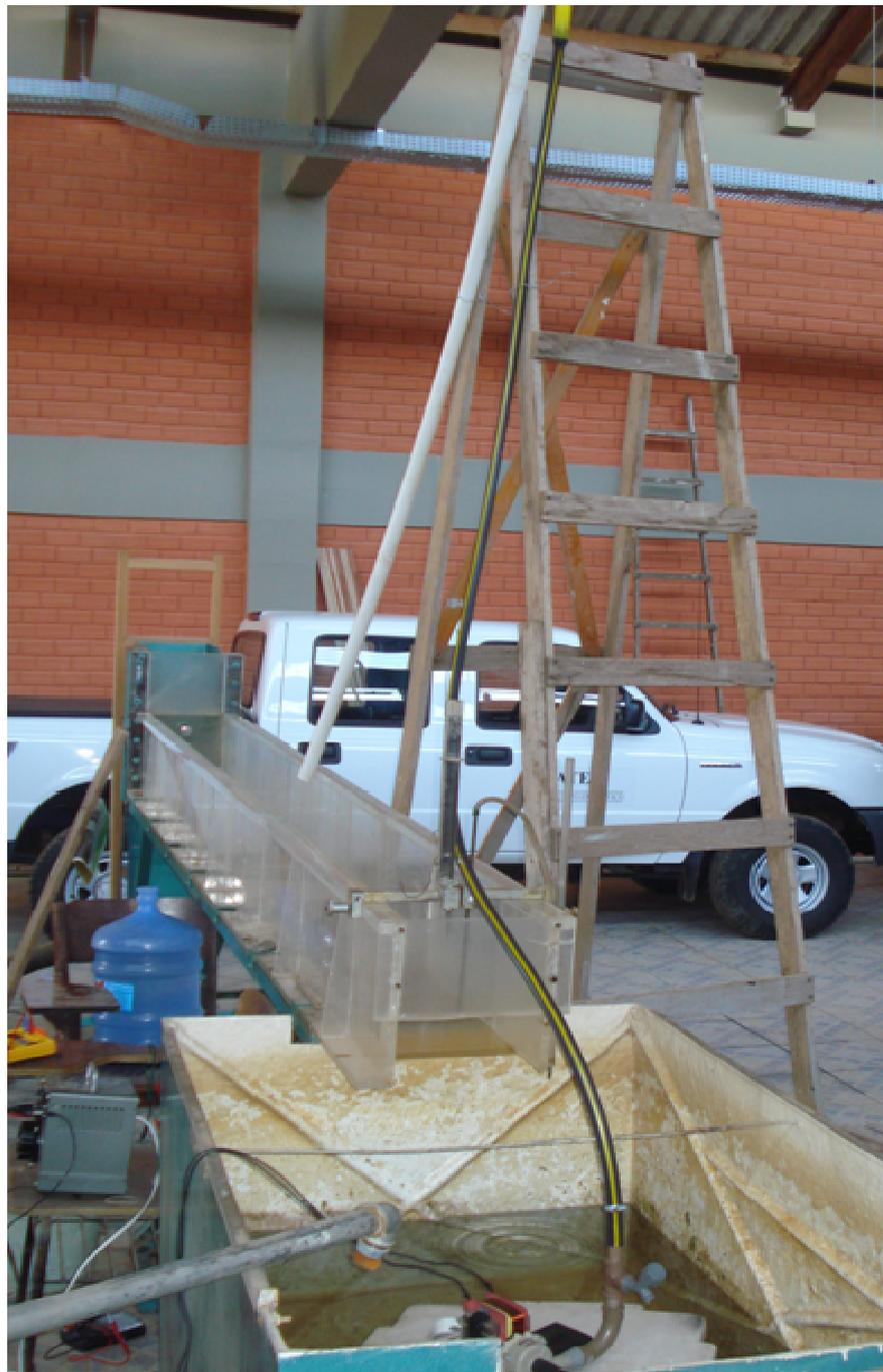
Figura 17 – Instalação experimental do bombeamento fotovoltaico.
