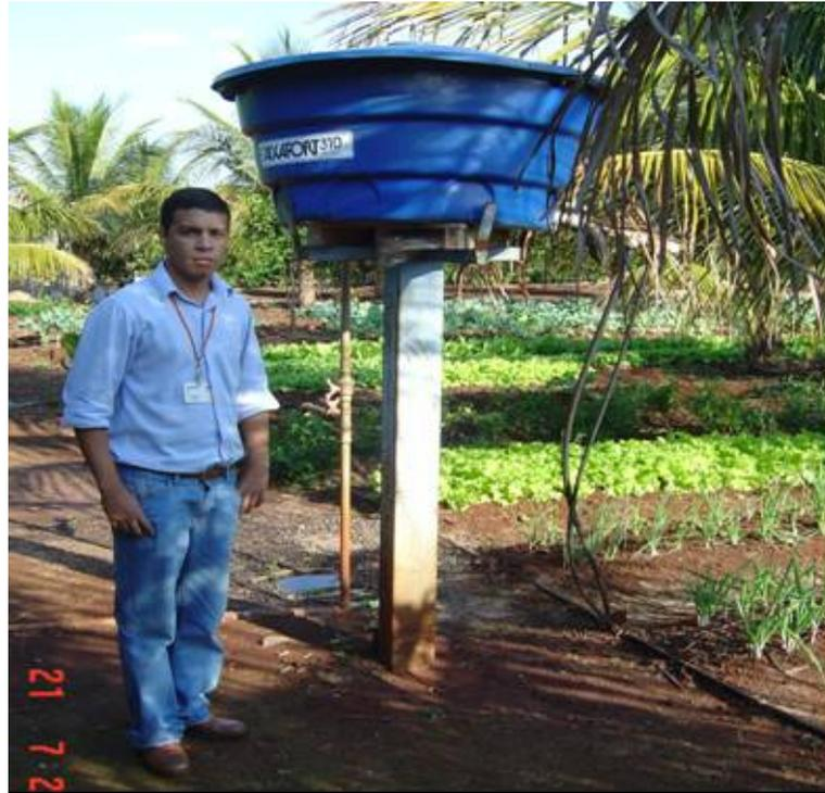
Figura 13 – Caixa de água para irrigação por gotejamento.
