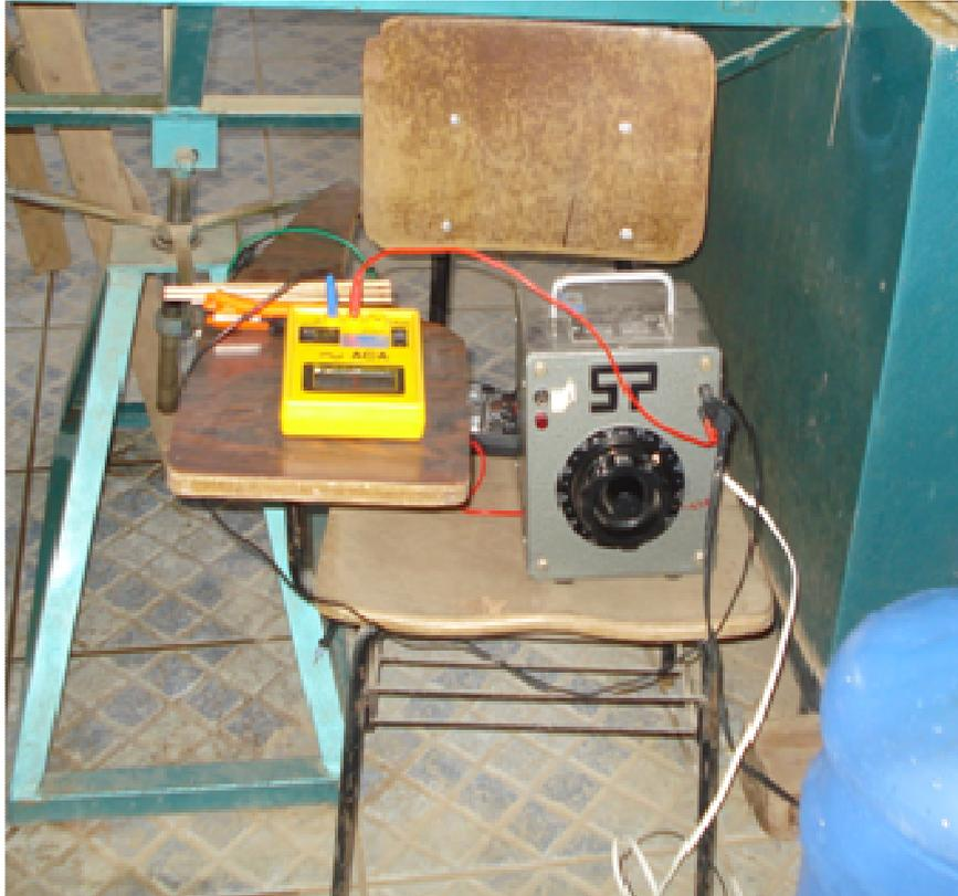
Figura 16 – Instrumentos de medições usados no motor CA da bomba.
