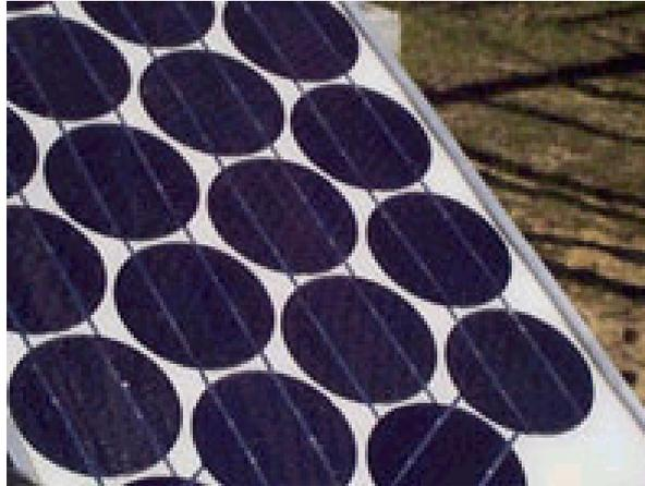
Figura 3 – Painel com células de silício monocristalino.
