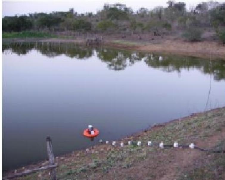
Figura 7 – Motobomba de superfície em um flutuador e tubulação de recalque.
