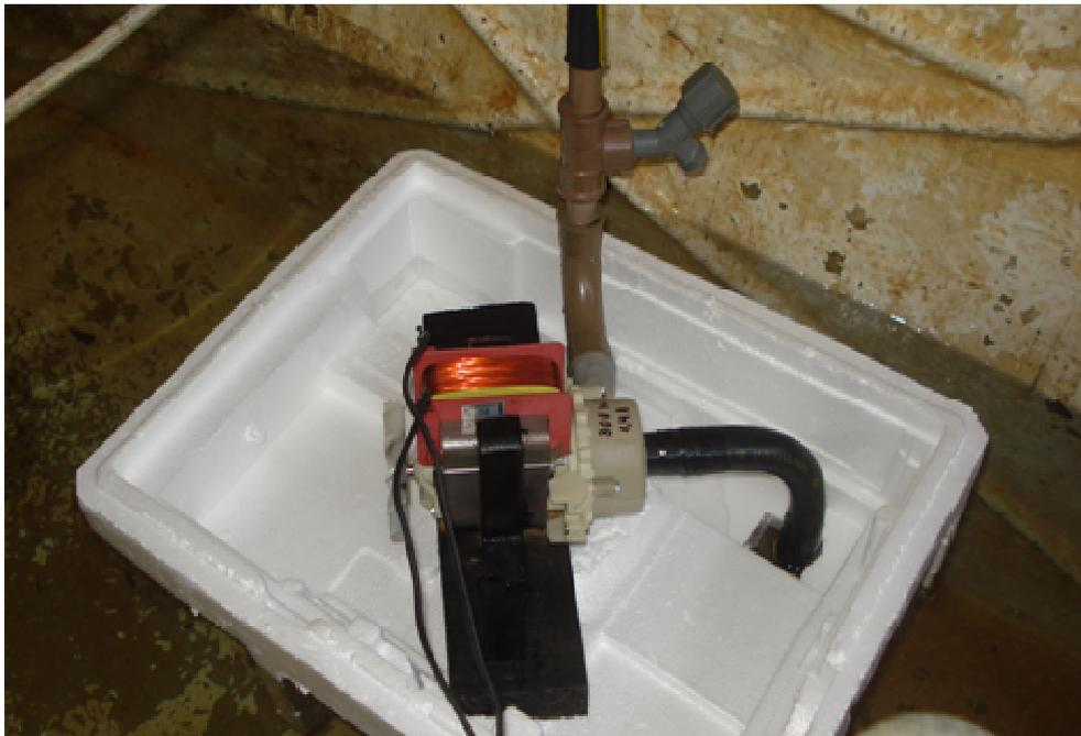
Figura 15 – Motobomba CA, monofásica com acessórios.
