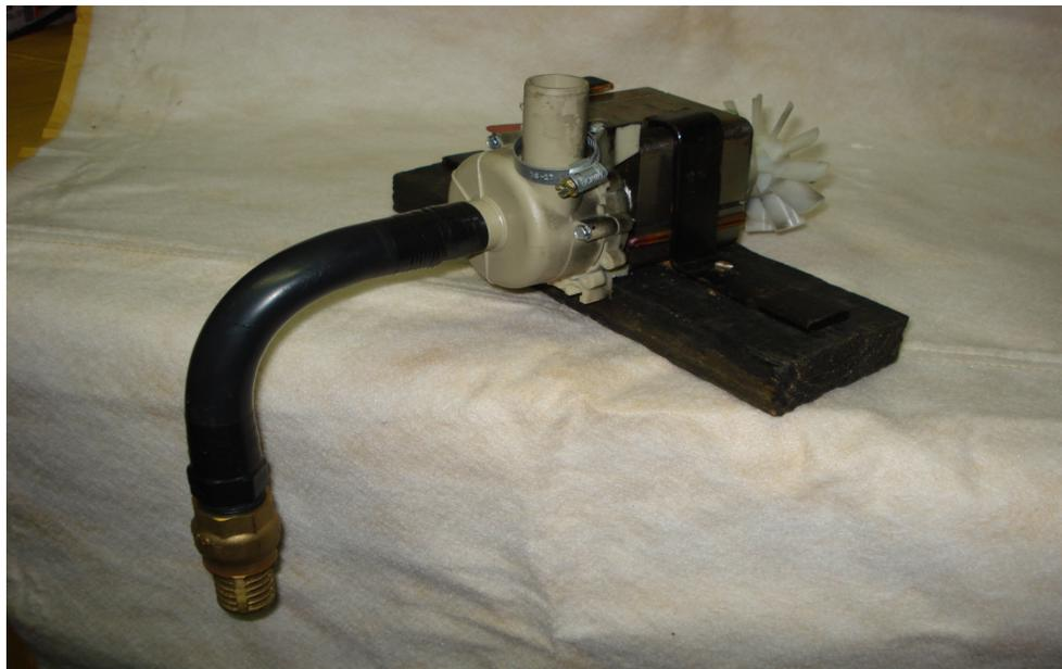
Figura 18 – Motobomba, sem acessórios na saída, reposicionada na plataforma.
