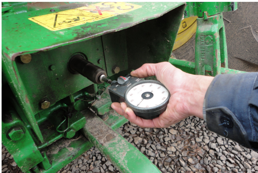
Figura 13 – Verificação da rotação da TDP por meio de um tacômetro analógico
