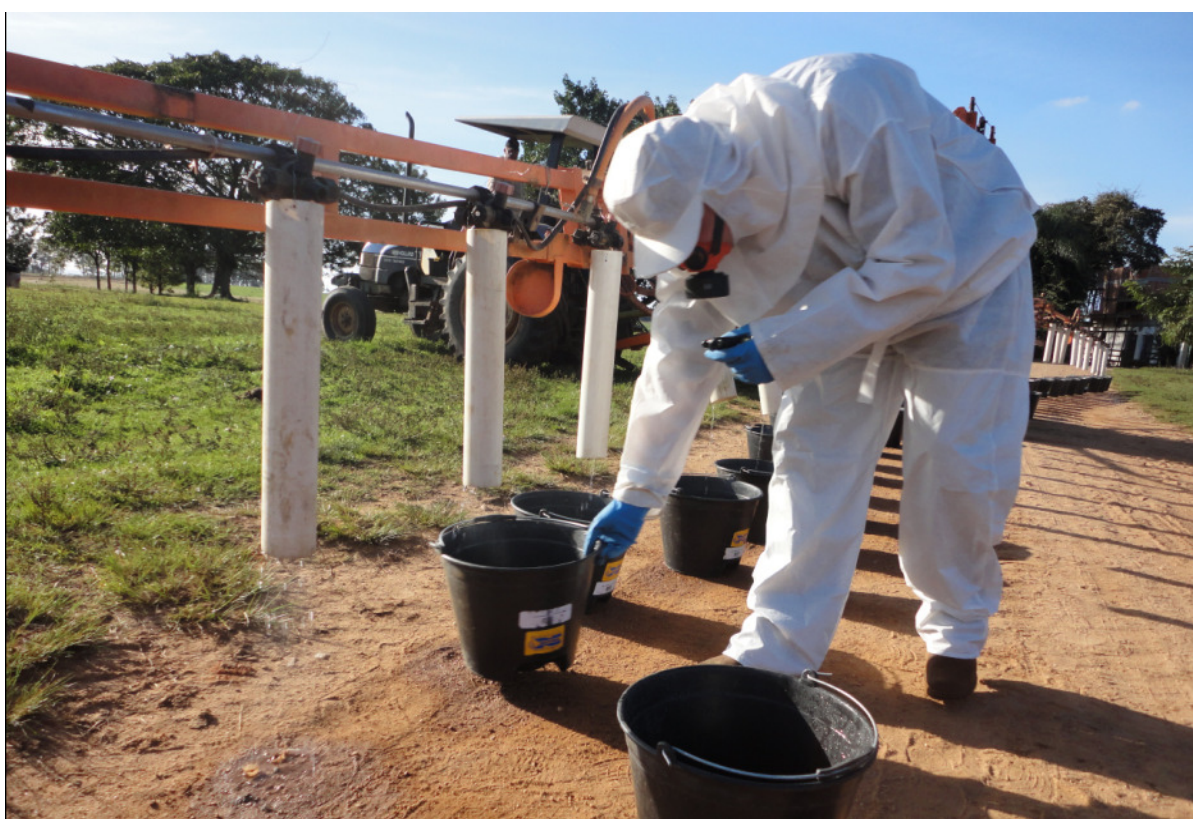
Figura 11 – Verificação da vazão por ponta de pulverização em 3 minutos.
