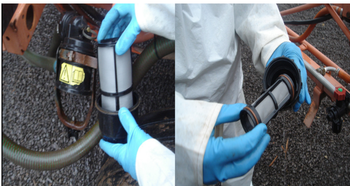
Figura 9 – Verificação da qualidade dos filtros e da presença de resíduos nos mesmos.
