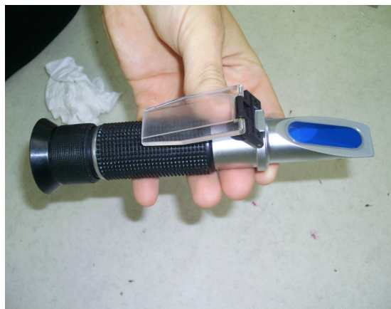
Figura 10 – Refratômetro para determinação do teor de SST (Colégio Politécnico da UFSM - Santa Maria-RS dezembro de 2010)
