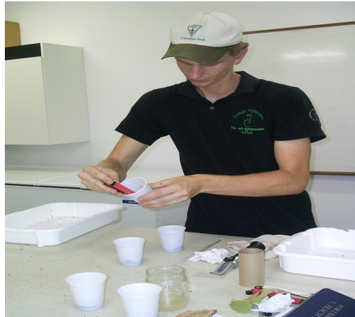
Figura 11 – Medição do pH do mosto, leitura com peagâmetro digital (Colégio Politécnico da UFSM - Santa Maria-RS dezembro de 2010)
