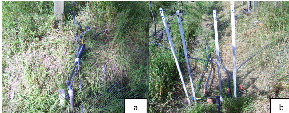
Figura 3 – Vista geral do experimento: a) acionamento do sistema de irrigação através de uma torneira e medida da pressão de serviço através de manômetro; b) acionamento independente dos tratamentos através de registros de esfera
