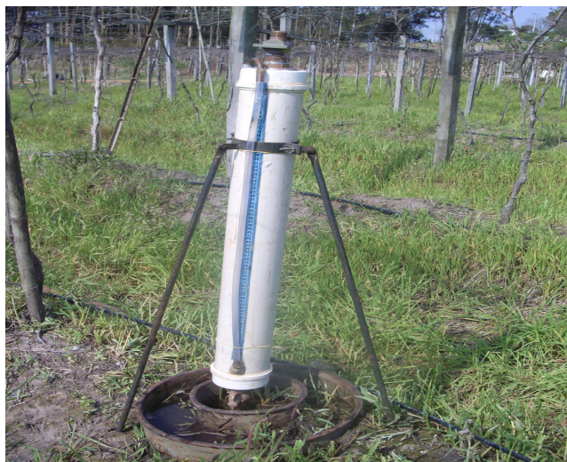
Figura 2 – Determinação da infiltração de água no solo, metodologia do duplo anel concêntrico. Santa Maria – RS (2010).
