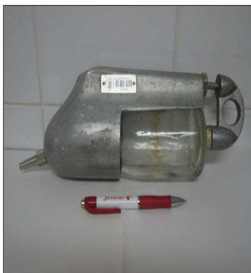
Figura 8 – Amostrador integrador na profundidade USDH 48 (AMS1).
