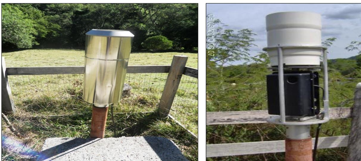
Figura 5 – Pluviógrafo da Estação Pluviométrica Maciel.
