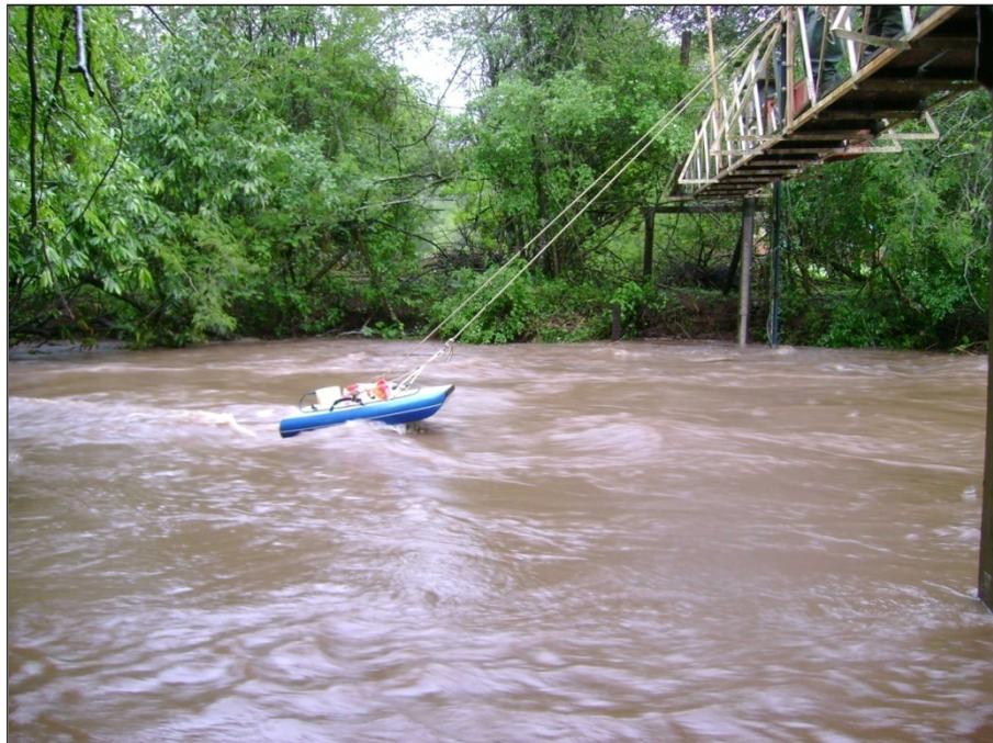
Figura 7 – Perfilador acústico de corrente por Efeito Doppler (ADP) em uma prancha hidrodinâmica.
