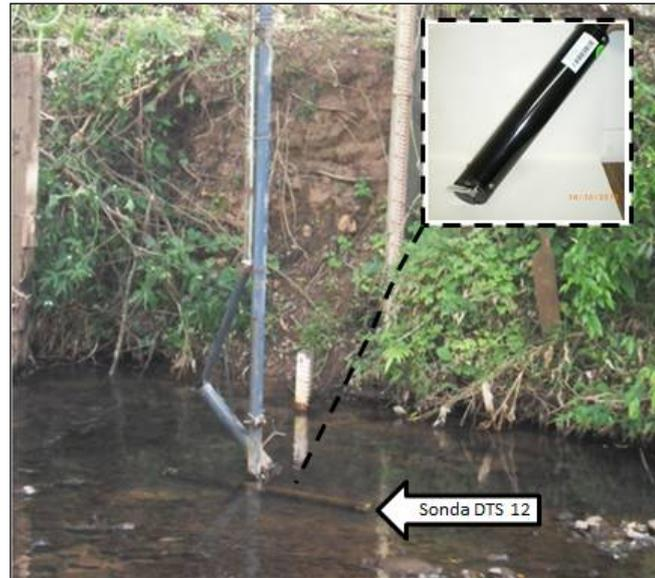
Figura 11 – Suporte e localização da sonda de turbidez.
