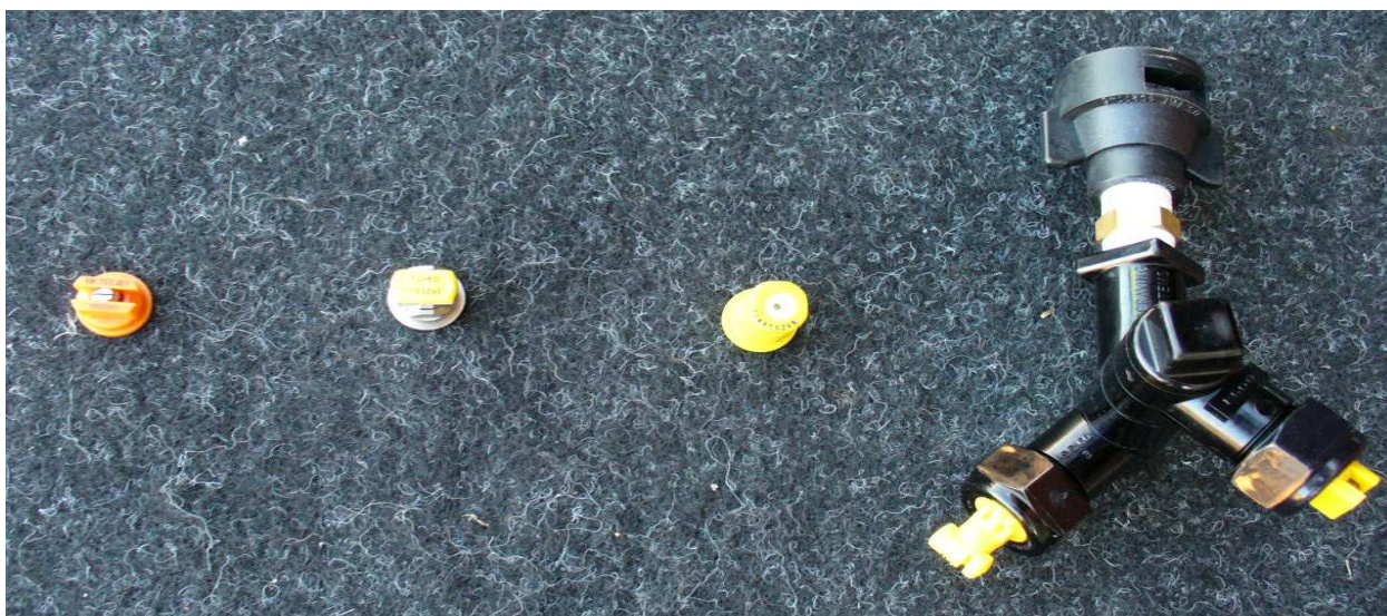
FIGURA 2 - Pontas de jato leque plano de uso ampliado (XR 11001), jato duplo leque (TJ-60 11002), cone vazio (TXA 8002) e o Turbo TeeJet® Duo (leque turbo (TT 11002) + leque plano ampliado (XR 11002)).
