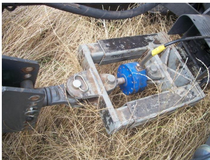
Figura 17 – Barra de tração com célula de carga.
