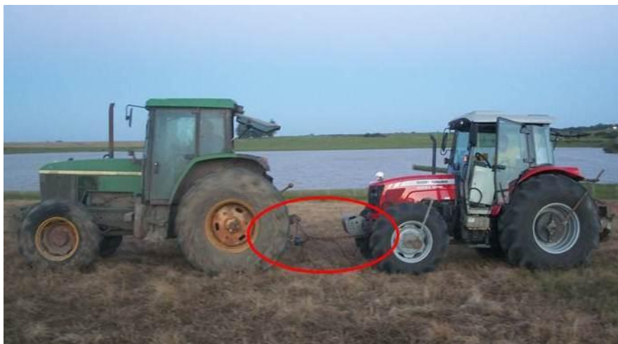
Figura 21 - Determinação da resistência ao rolamento com célula de carga.
