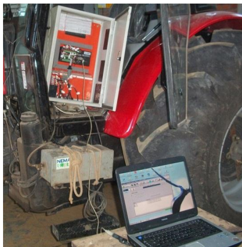
Figura 16 – Transferência dos dados para um microcomputador.
