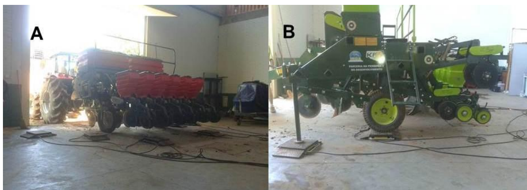
Figura 14 - Pesagem das semeadoras (A) MF 407; (B) KF 8/5 Hiper Plus
