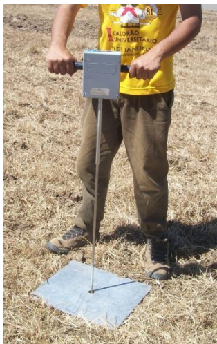
Figura 10 - Determinação da resistência à penetração com auxílio de penetrômetro.
