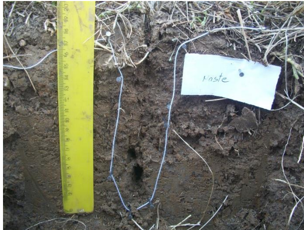
Figura 22 - Determinação da profundidade de trabalho dos mecanismos sulcadores.
