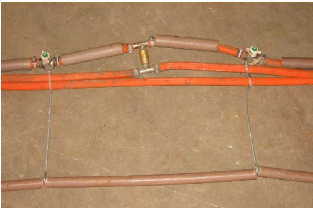
FIGURA 14 – Mangueiras de aplicação, alimentação e cabo de aço.
