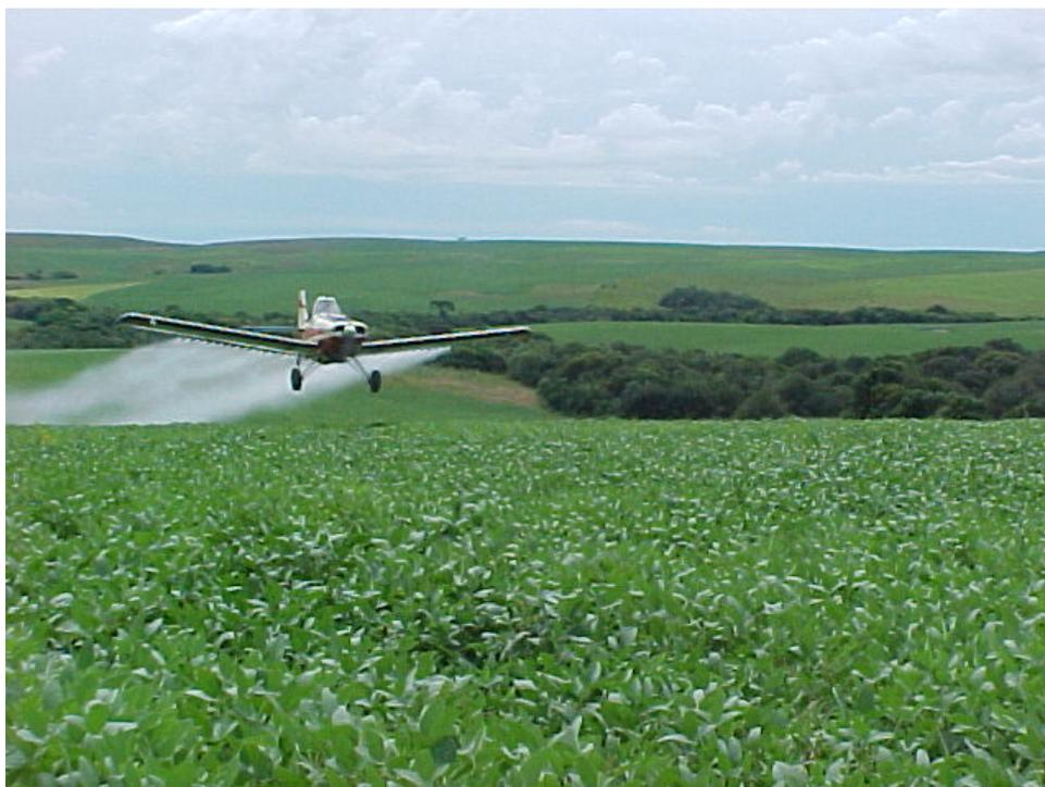
FIGURA 07 - Vista da aplicação de fungicida com avião agrícola Ipanema.
