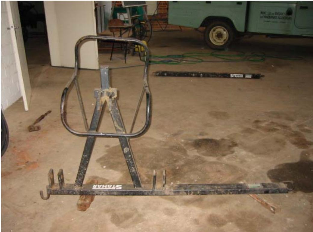
FIGURA 11 – Fixadores para tratores ou pulverizadores.
