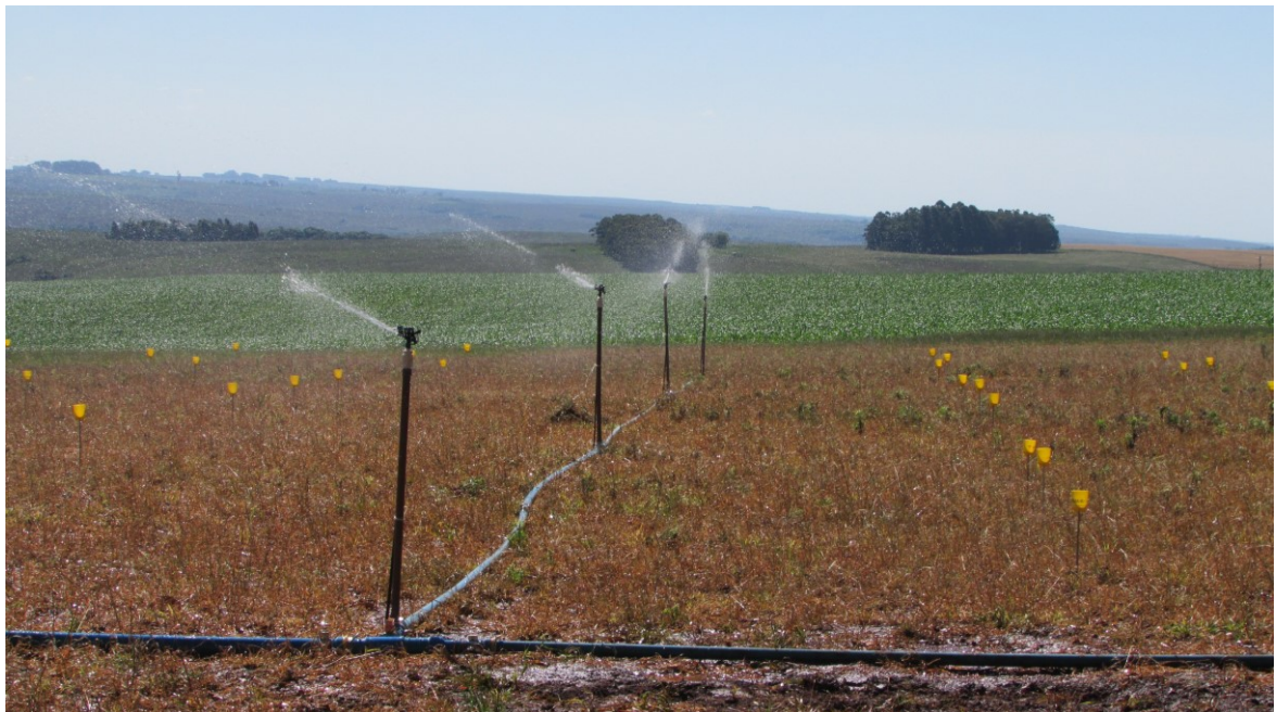
Figura 3 – Determinação do Coeficiente de Uniformidade de Christiansen (CUC).
