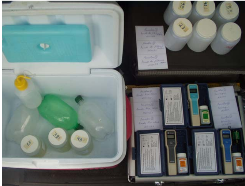
FIGURA 5- Detalhe dos equipamentos de medida “in situ” utilizados na análise de água dos mananciais. (Zamberlan, 2007)
