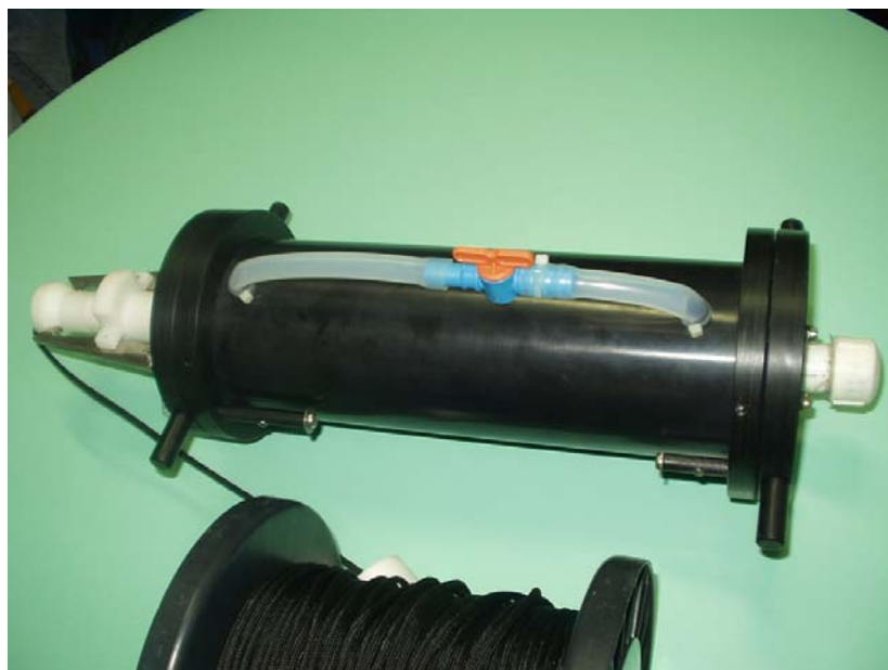
FIGURA 4- Detalhe da garrafa de Kemmerer utilizada nas coletas. (Zamberlan, 2007)
