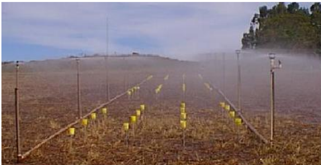
FIGURA 5. Teste de simulação de chuva para escolha dos bocais dos aspersores e intensidades de chuva a serem simuladas nos testes de escoamento superficial de água sob plantio direto com mulching vertical. Passo Fundo – RS.
