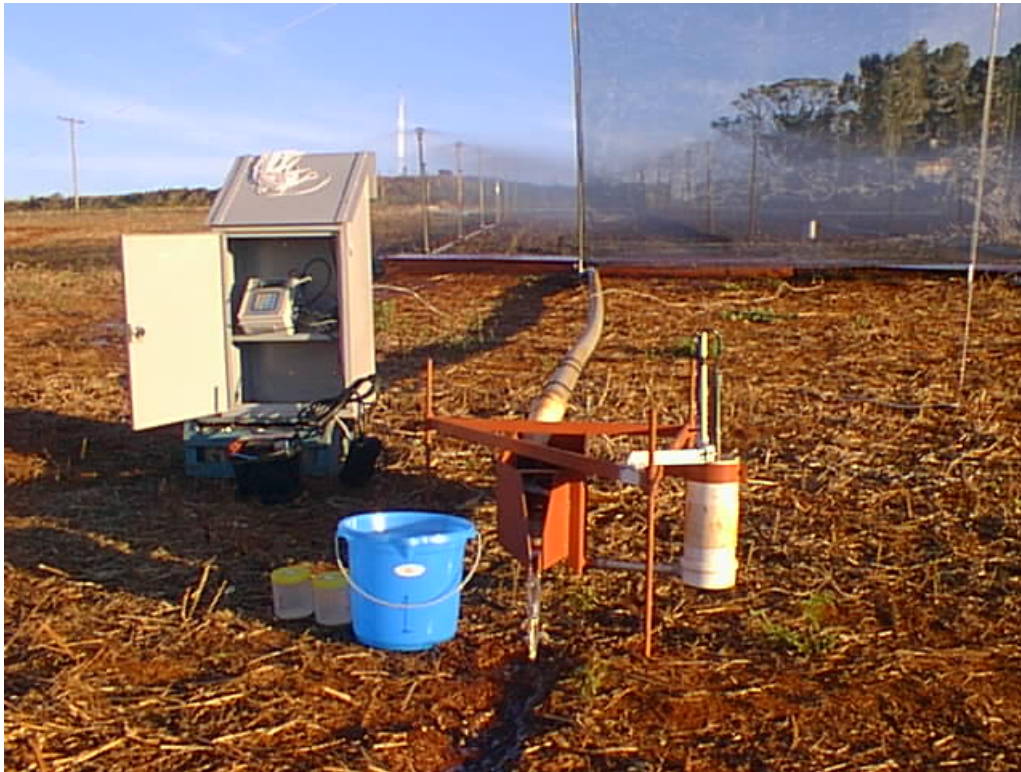
FIGURA 8. Sistema de determinação do escoamento superficial com sensor de nível, juntamente com armazenador de dados digital ( data logger ), localizado dentro da proteção. Passo Fundo – RS.
