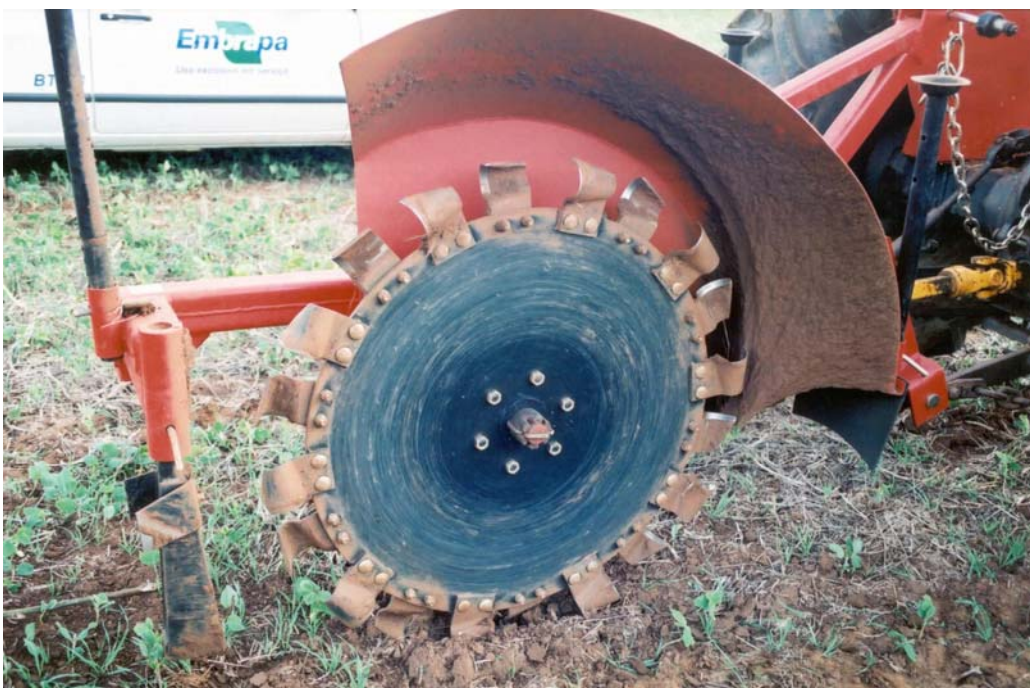
FIGURA 2. Valetadeira rotativa adaptada para abertura dos sulcos para a confecção do mulching vertical. Passo Fundo – RS.
