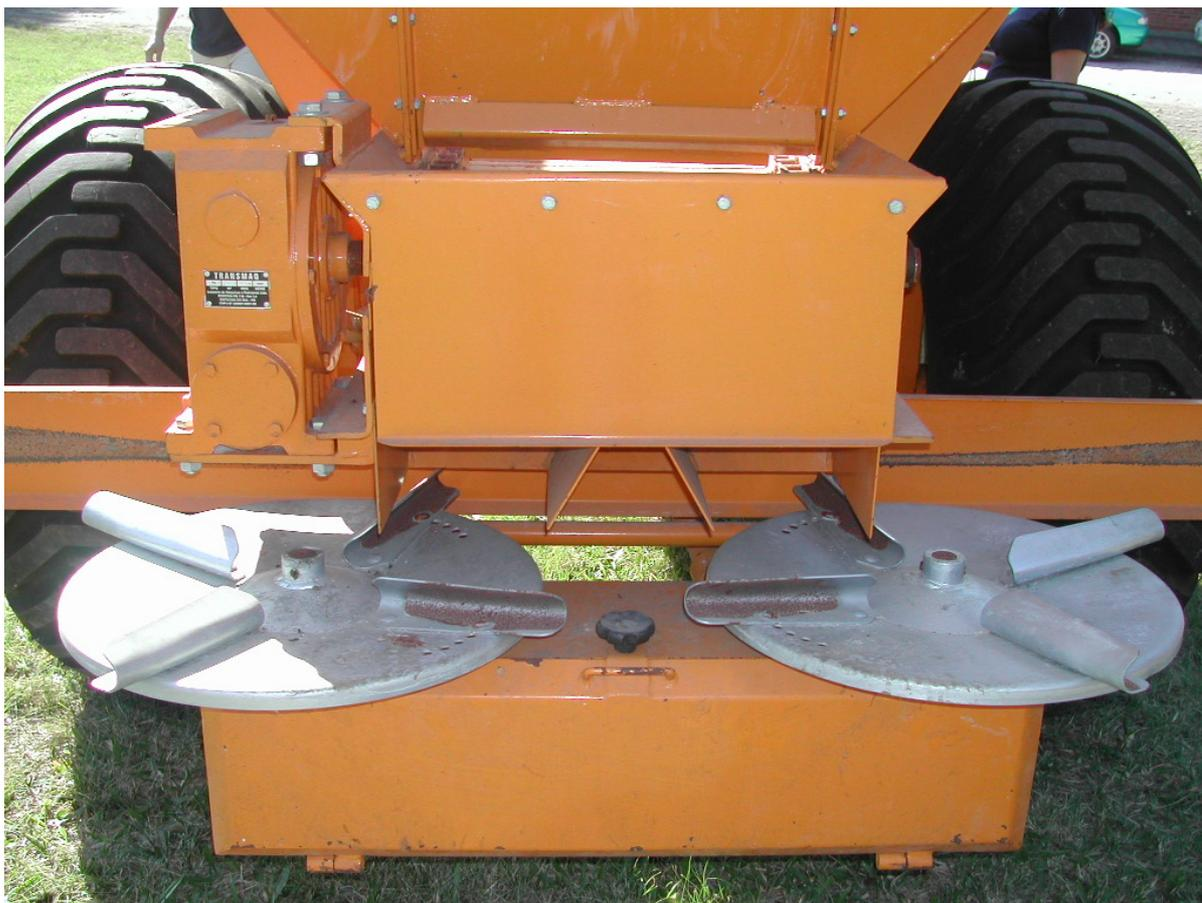
Figura 3 - Vista do sistema de distribuição de produtos do distribuidor utilizado para avaliar o efeito da regulagem no perfil transversal de aplicação, constituído por dois discos. Santa Maria, RS, 2003.
