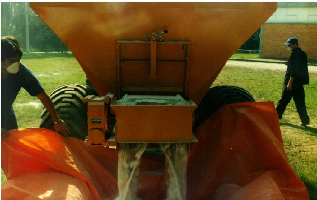
Figura 10 - Vista do distribuidor Boelter durante a determinação de vazão do calcário, sem os discos distribuidores. Santa Maria, RS, 2003.
