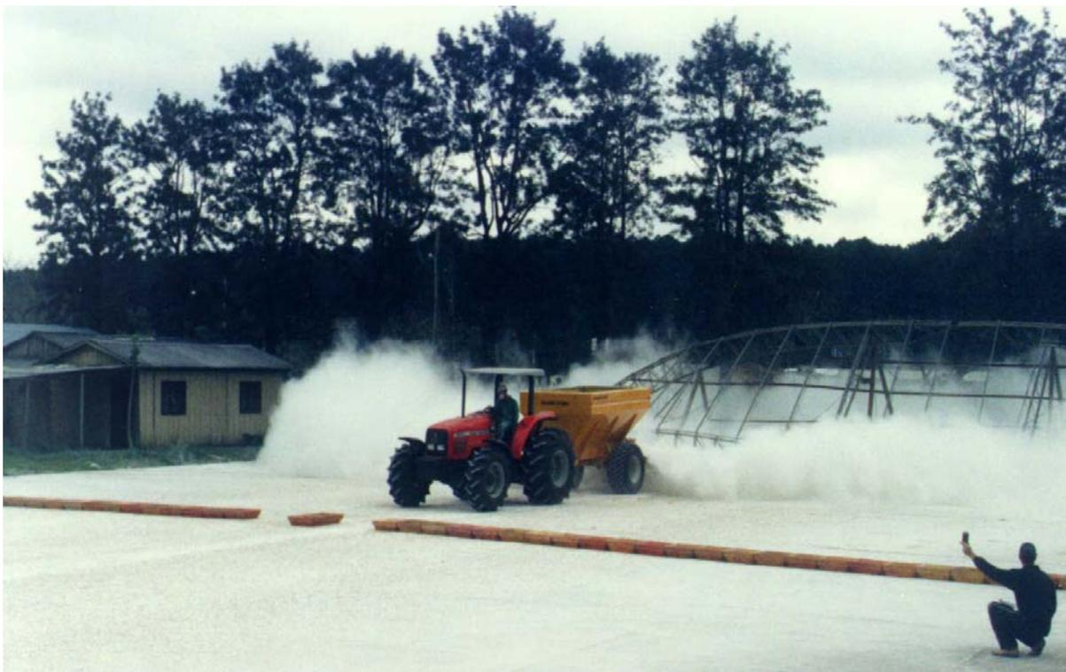
Figura 11 - Posição do conjunto mecanizado trator-distribuidor centrífugo, passando pela linha de bandejas durante determinação do perfil de distribuição transversal de calcário com distribuidor centrífugo Boelter. Santa Maria, RS, 2003.
