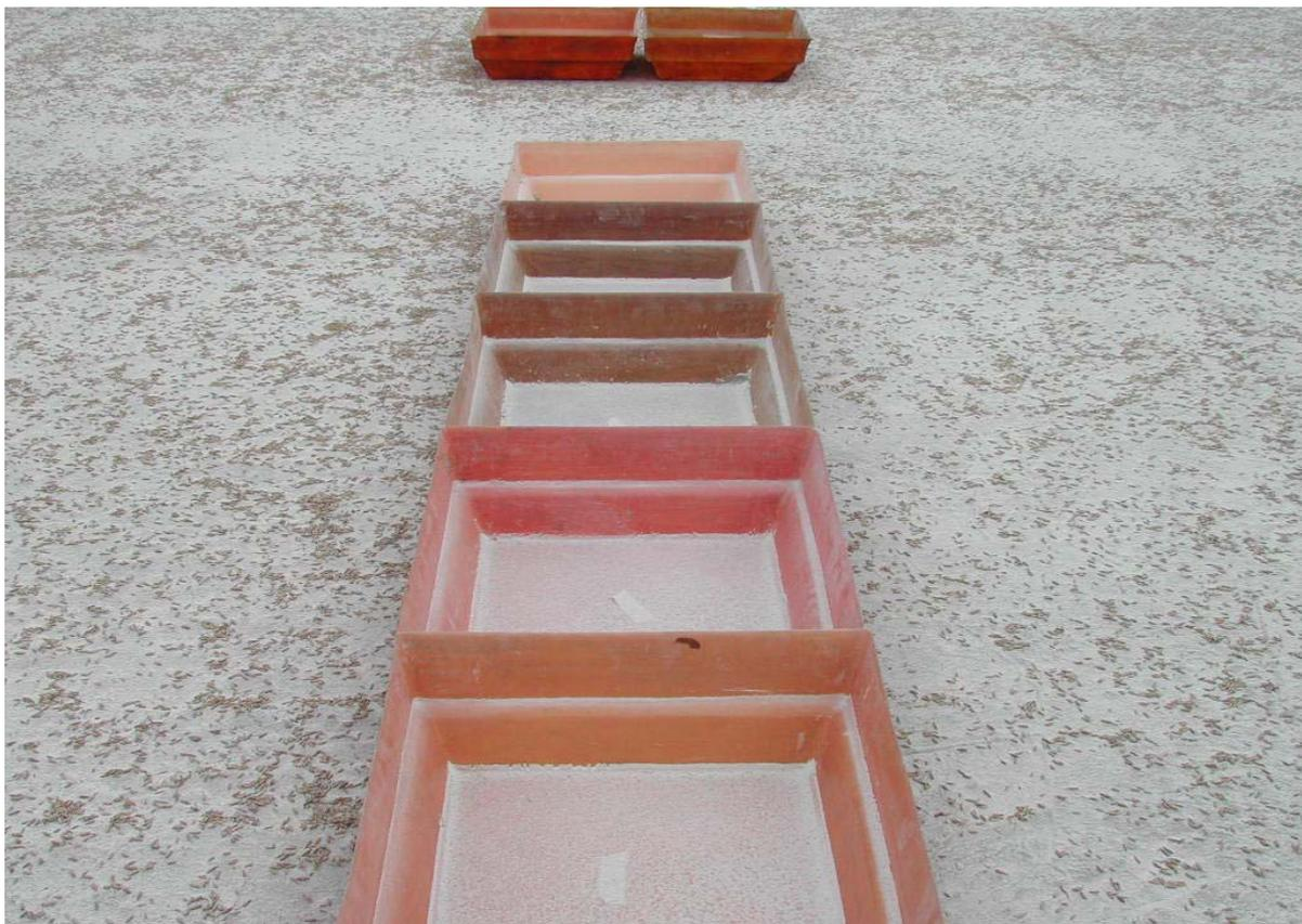
Figura 8 - Bandejas padronizadas pela Norma ISO 5690, utilizadas no trabalho de avaliação do distribuidor Boelter, dispostas para a determinação do perfil transversal. Santa Maria, RS, 2003.
