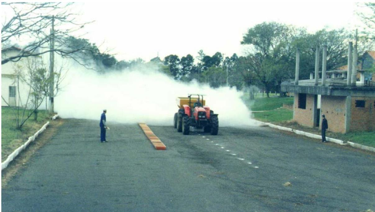
Figura 15 - Conjunto mecanizado trator-distribuidor centrífugo passando pela linha de bandejas durante a aplicação para determinação do perfil de distribuição longitudinal de calcário. Santa Maria, RS, 2003.
