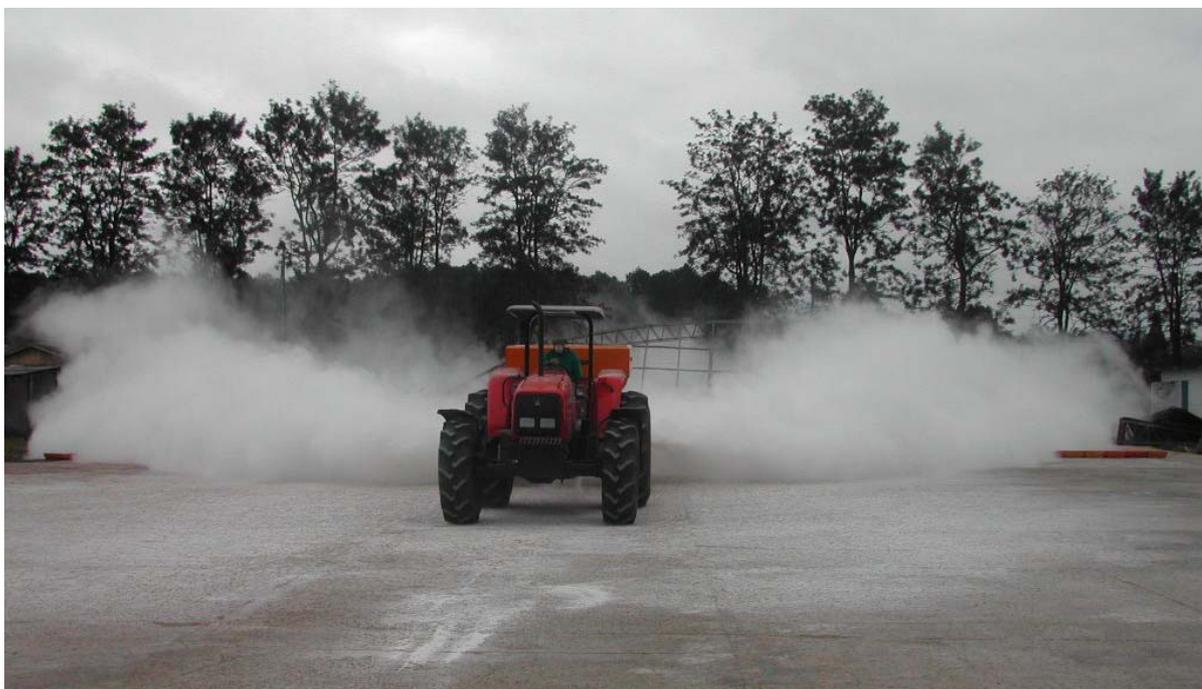
Figura 6 - Posição do conjunto mecanizado trator-distribuidor centrífugo após ter ultrapassado a linha de bandejas durante determinação do perfil de distribuição transversal de calcário com distribuidor centrífugo Boelter. Santa Maria, RS, 2003.
