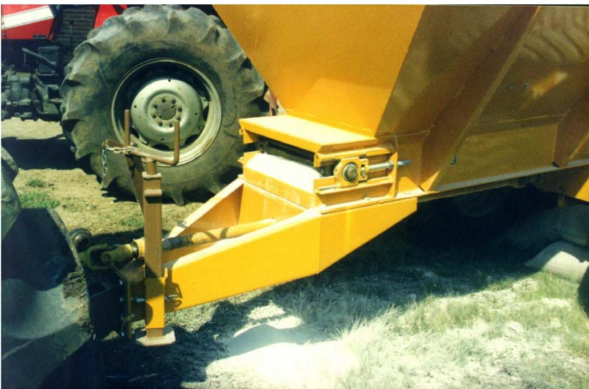
Figura 39 - Acúmulo e queda de calcário na parte frontal da esteira durante os trabalhos de determinação da vazão do distribuidor centrífugo Boelter. Santa Maria, RS, 2003.
