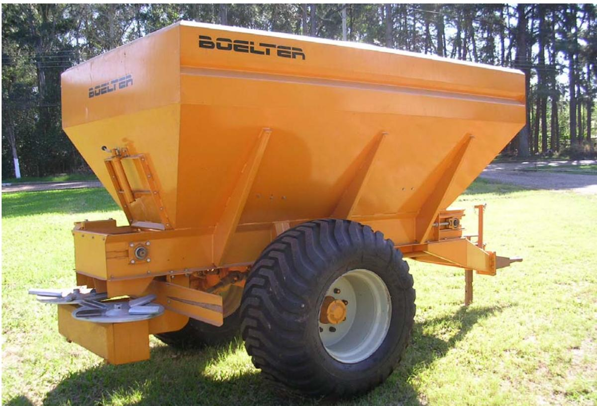
Figura 2 - Vista geral do distribuidor centrífugo utilizado para avaliar o efeito da regulagem no perfil transversal de aplicação. Santa Maria, RS, 2003.
