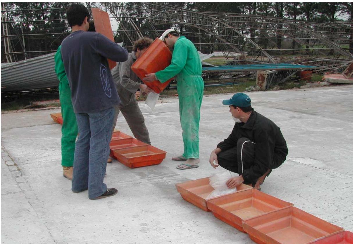
Figura 13 - Coleta do material acumulado nas bandejas após a passagem do distribuidor centrífugo Boelter. Santa Maria, RS, 2003.
