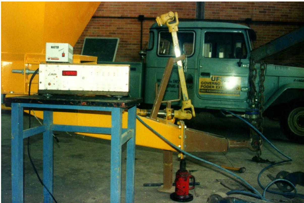
Figura 9 - Medição da transferência de peso do distribuidor Boelter para a barra de tração do trator, pelo método dinamométrico.
