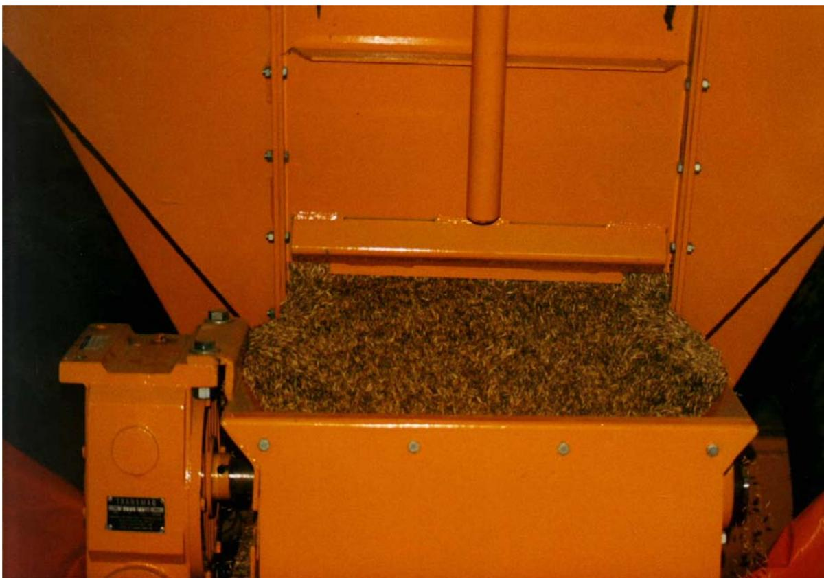
Figura 18 - Mecanismo dosador apresentando queda de semente de aveia na lateral da esteira do distribuidor centrífugo Boelter. Santa Maria, RS, 2003.
