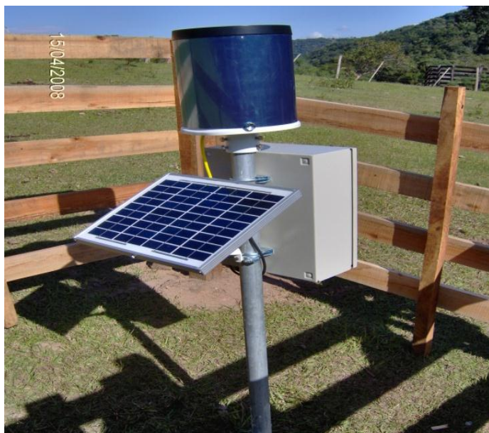
Figura 16 - Pluviógrafo localizado na microbacia Rancho do Amaral, próximo ao poço 05. Estação GHIDROS-UFSM.
