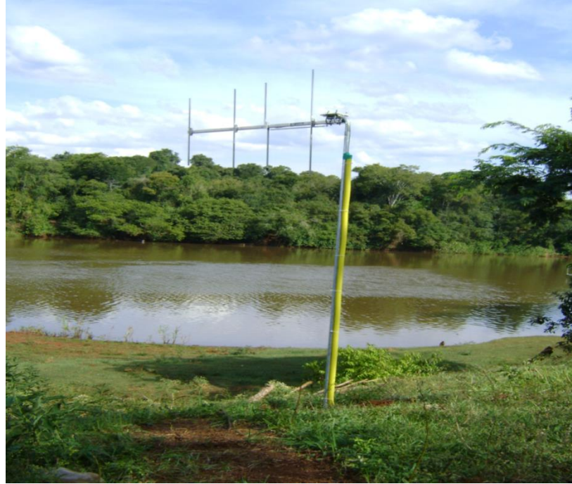
Figura 7 – Antena de captação de sinais telemétricos emitidos pelos tags implantados nos peixes. Fonte: ELETROSUL (2009).
