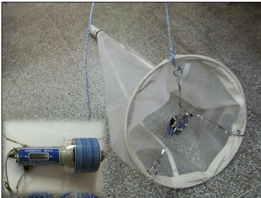
Figura 22 – Rede de ictioplâncton com fluxômetro mecânico acoplado e em detalhe.
