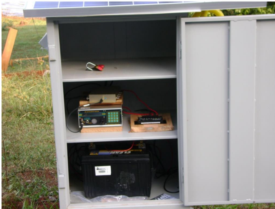
Figura 6 – Receptor telemétrico instalado próximo as antenas de captação dos sinais dos tags implantados nos peixes. Fonte: ELETROSUL (2009).
