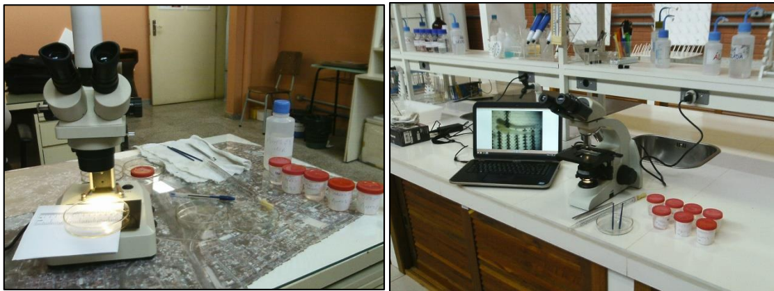
Figura 25 – Demonstração do processo de triagem das amostras com auxílio de estereomicroscópio (esquerda) e microscópio (direita).
