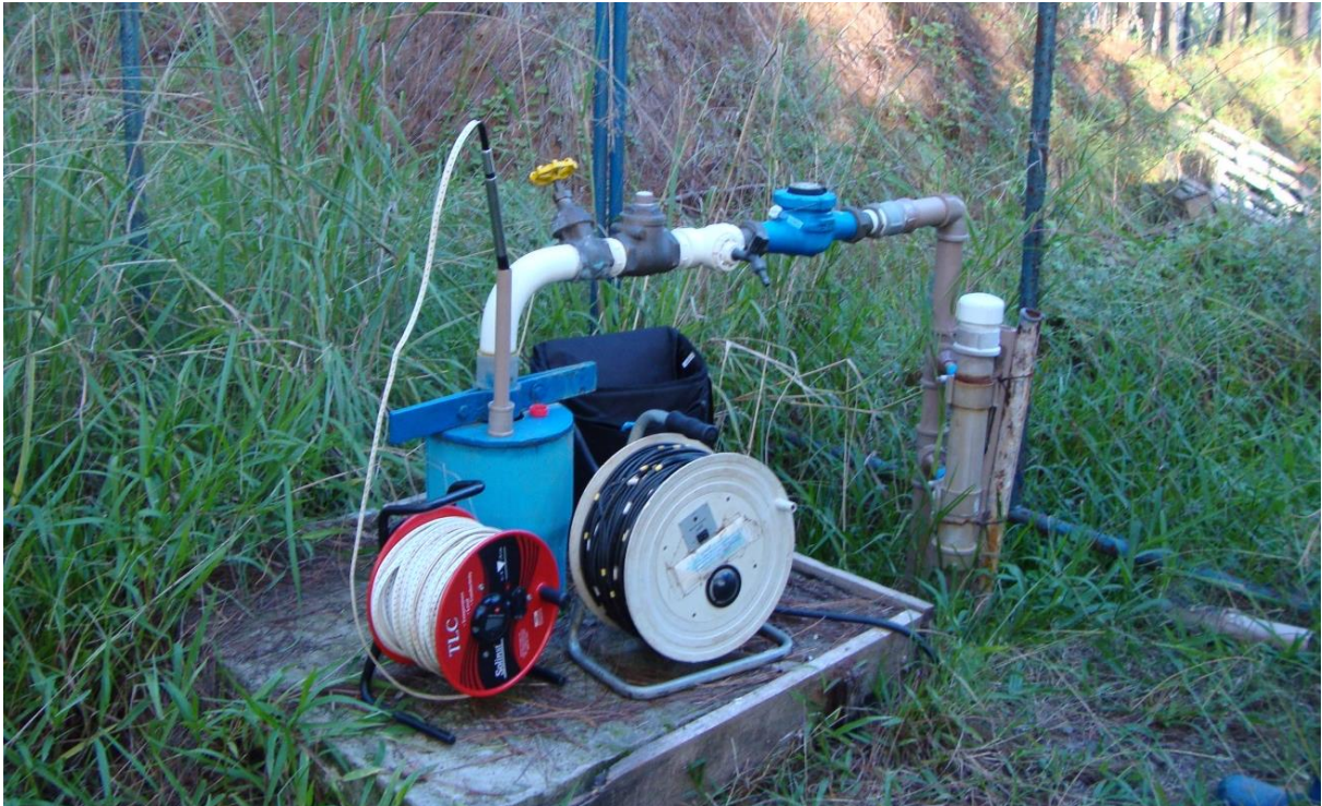
Figura 6 - Medições de níveis das águas subterrâneas do Campus da UFSM em poço tubular dotado de tubo guia, poço Estrada do Jardim Botânico (ativo).
