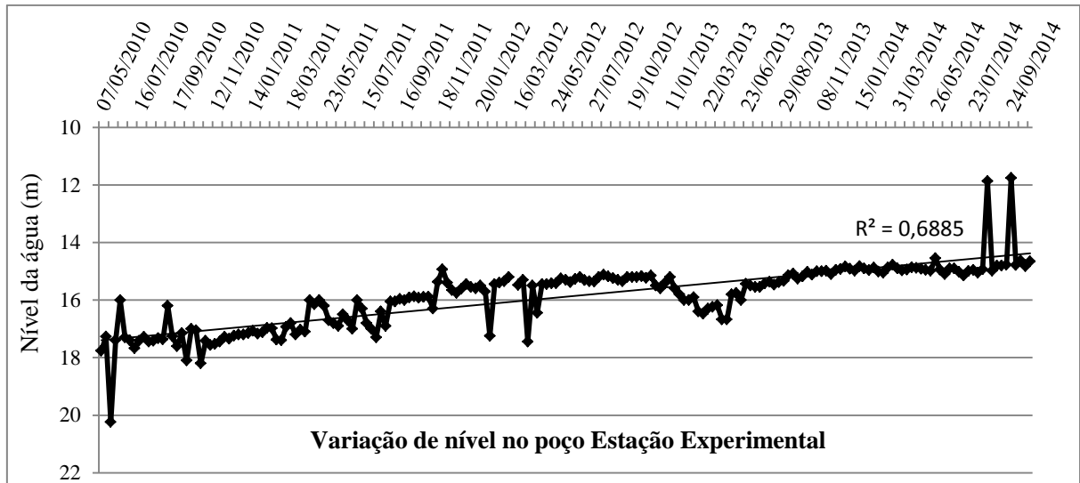
Figura 23 - Variação do NA subterrânea no poço Estação Experimental, no período de 07/05/2010 a 23/10/2014, com registros de frequência semanal (n=197).
