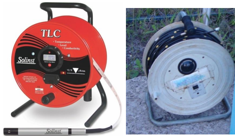
Figura 5– Medidor de nível da marca Solinst TLC, e medidor sonoro de nível da marca Jacirí, ambos com cabo de 100 m.
