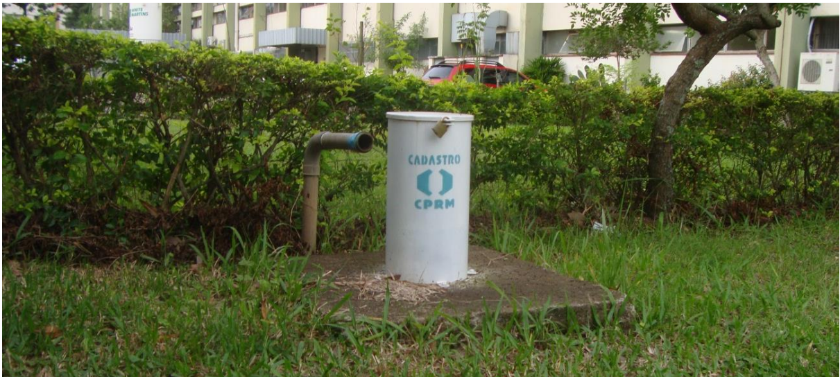
Figura 4 - Poço FATEC Velho (PB20, desativado), monitorado pelo projeto RIMAS/CPRM, com registrador automático horário (desativado).
