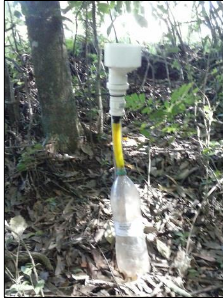
Figura 7 - Interceptômetro utilizados para captação da precipitação interna, instalado na área experimental II.
