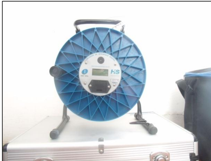
Figura 17 – Medidor de nível digital modelo HSIFD-30, com sonda de interface água/óleo, para verificação de presença ou ausência de LNAPL e DNAPL
