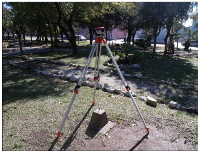
Figura 9 – Nível óptico estacionado sobre a Estação Geodésica IBGE (RN 1797S), visando à transposição de cotas até a área do estudo
