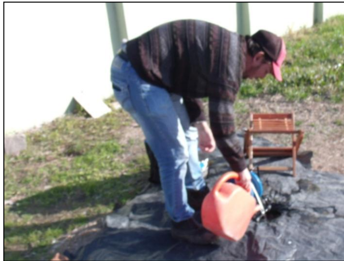
Figura 14 – Processo de adição de água para saturação da zona vadosa fixada até o nível inicial do ensaio na ST 15
