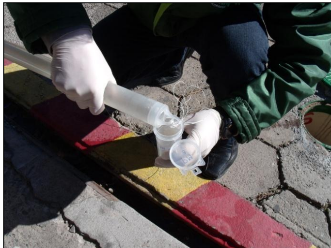
Figura 18 – Coleta de amostras de água subterrânea no PM 03, existente na área do estudo, para posterior envio ao LabMicro/UFSM.
