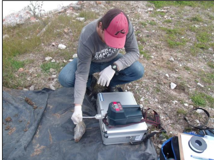
Figura 16 – Medição de COV in situ , com analisador de vapor THERMO GASTECH Innova SV
