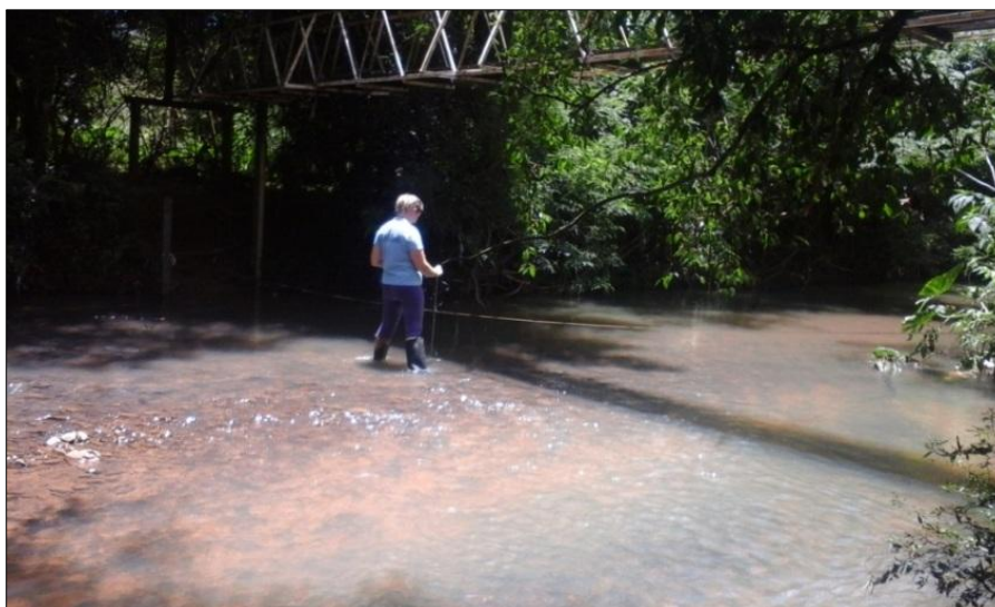
Figura 26- Medição da velocidade com o uso do molinete hidrométrico
