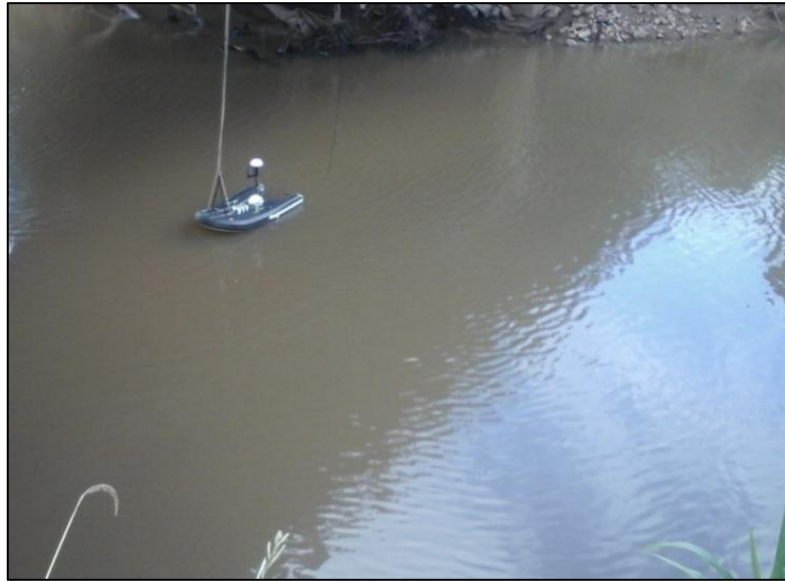
Figura 27 - Medição de vazão, profundidade e velocidade média com a ADCP na seção fluviométrica da bacia RSC 287
