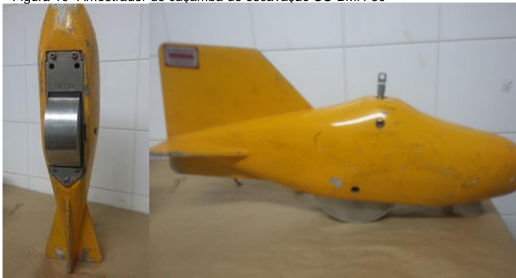
Figura 10- Amostrador de caçamba de escavação US-BMH-60
