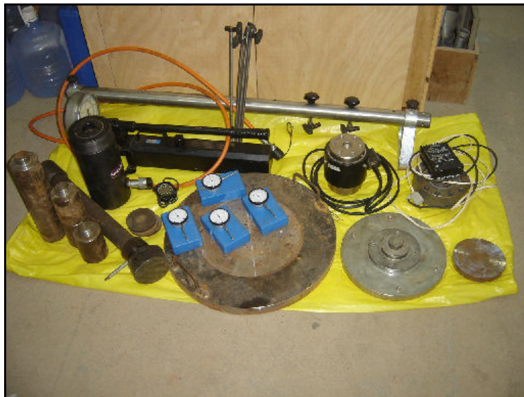
Figura 3. 1 – Equipamentos para a realização dos ensaios de placa
