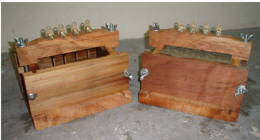
Figura 3.4 – Fôrma utilizada na moldagem dos corpos-de-prova para o ensaio de resistividade elétrica aparente
