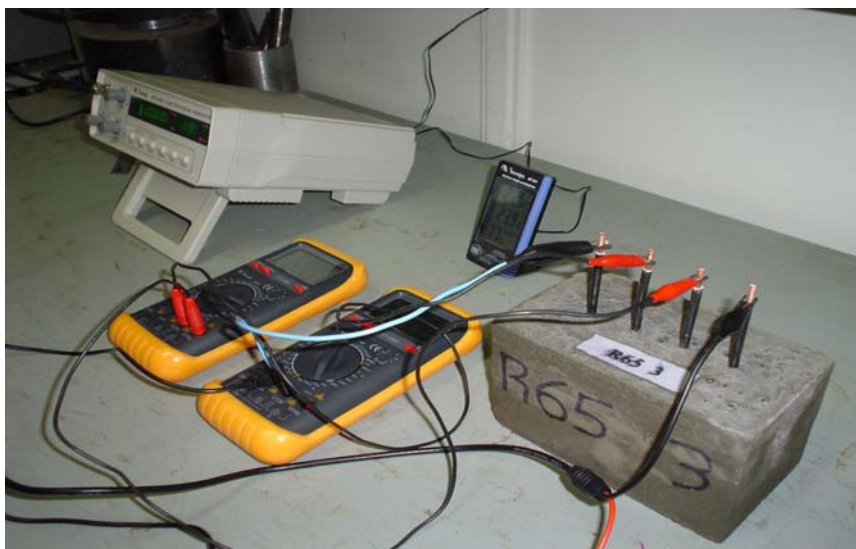
(b) circuito montado – pronto para leitura
