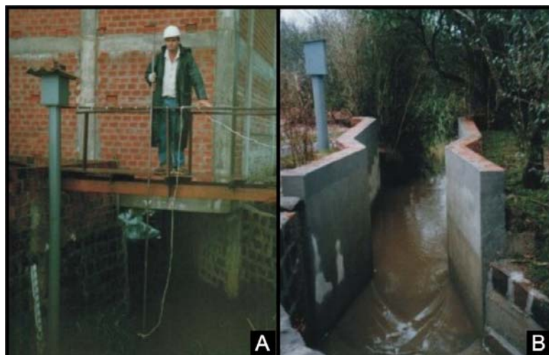
FIGURA 11. Estações fluviográficas de monitoramento. A. Estação Alto da Colina I B. Estação Alto da Colina II
