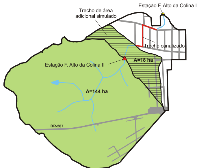
FIGURA 42. Esquema utilizado na simulação dos eventos extremos
