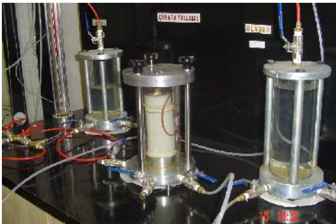
Figura 3.3 – Equipamento de ensaio k com câmara triaxial e “ bladers ”
