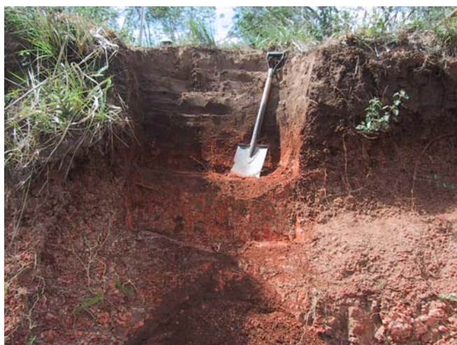
Figura 3.2 – Trincheira aberta no perfil 1 para retirada de amostras indeformadas
