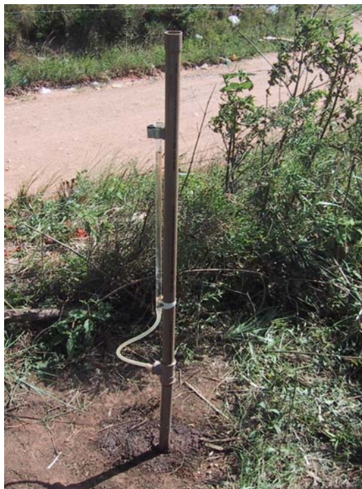
Figura 3.7 – Piezômetro instalado no campo
