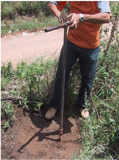
Figura 3.5 – Execução do furo de com trado manual
