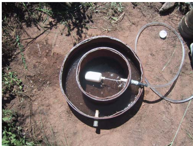
Figura 3.9 – Infiltrômetro de anel utilizado no estudo
