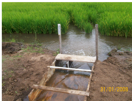
Figura 3.13 - Terceira tentativa de medição de velocidades Fonte: Acervo GERHI.
