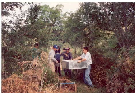
Figura 2.7 - Método de medição pela cubagem. Fonte: Acervo GERHI.
