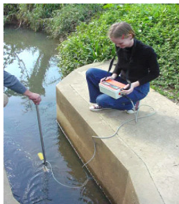
Figura 2.9 - Sensor Eletrônico de Velocidade Nautilus C 2000. Fonte: Acervo GERHI.
