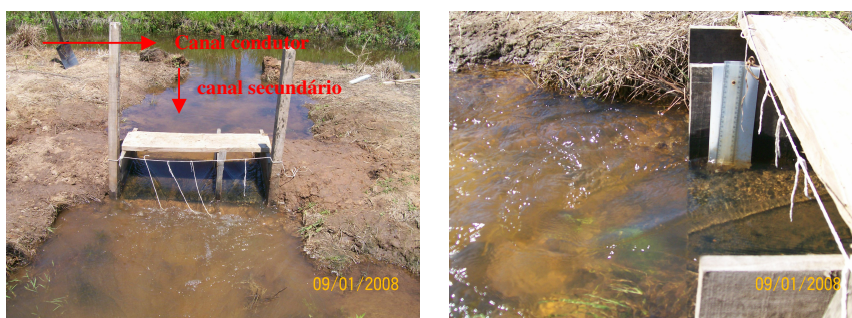
Figura 3.12 - Segunda tentativa de medição de velocidades Fonte: Acervo GERHI.
