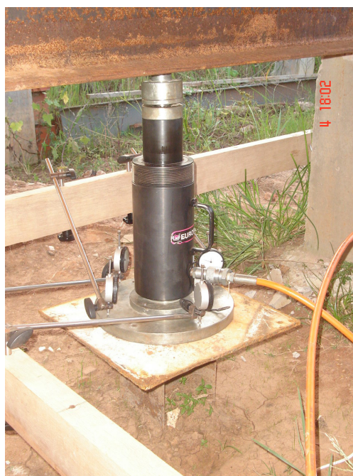
Fig. 4.12 – Macaco hidráulico, calços e placa
