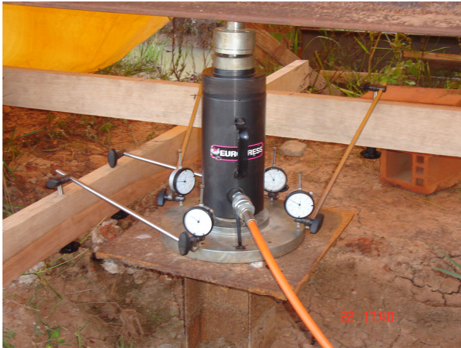
Fig. 4.14 – Disposição dos deflectômetros sobre a placa
