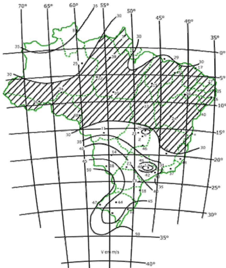
Figura 2 – Isopletas da velocidade básica  $V_0$  (m/s).
