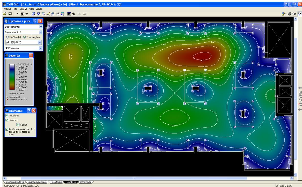
**Figura 21 – Tela do CYPECAD – Diagrama de isovalores de deslocamentos no Pavimento Tipo.**
