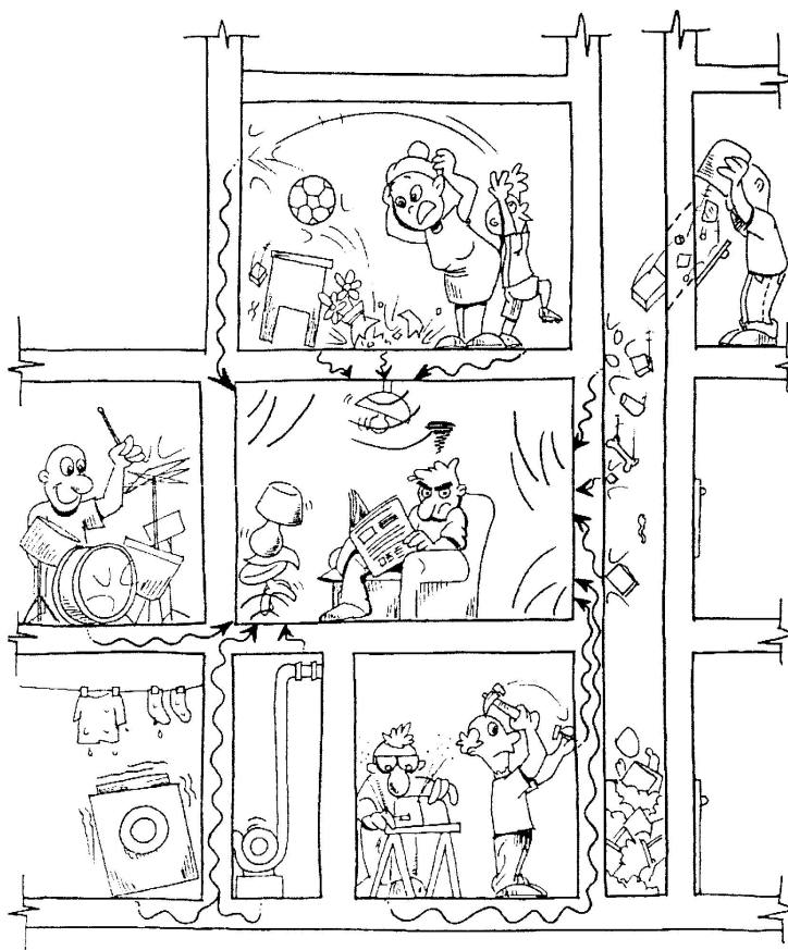
Figura 3 – Transmissão de ruídos de impacto e vibrações (Souza et al., 2003, p. 97).
