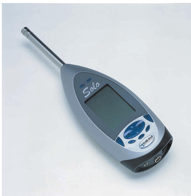
Figura 24 – Medidor de nível sonoro de integração e registro de dados. (Manual técnico Blue Solo 01, 2003, p. 1).
