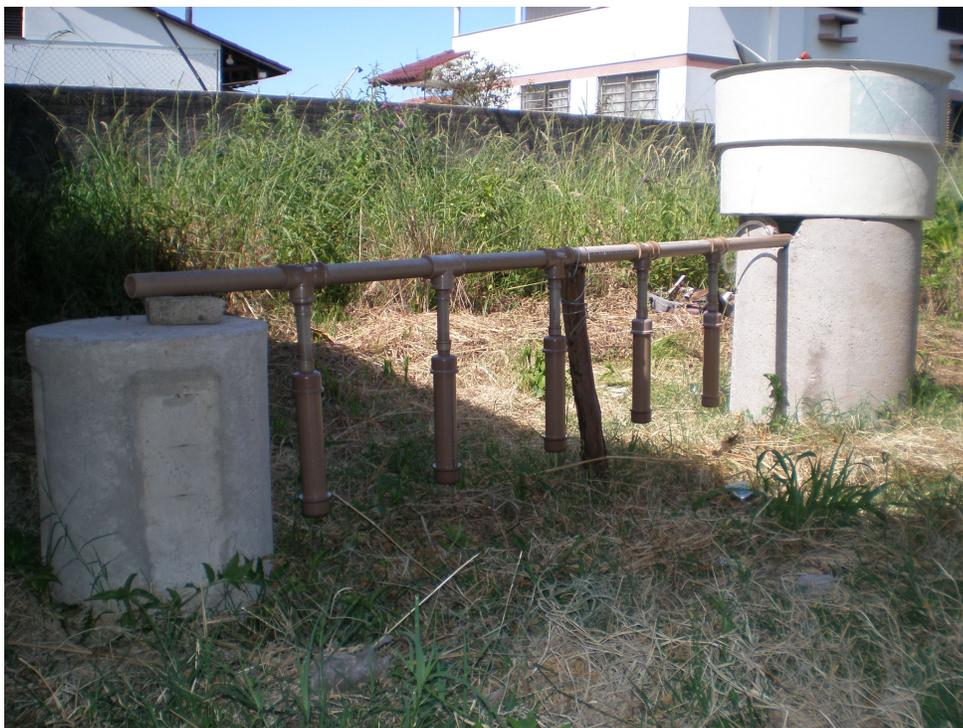
Figura 3.2 – Amostrador que coleta água diretamente da atmosfera.
