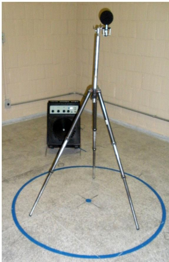
Figura 15 – Tripé (na imagem, com o microfone utilizado).
