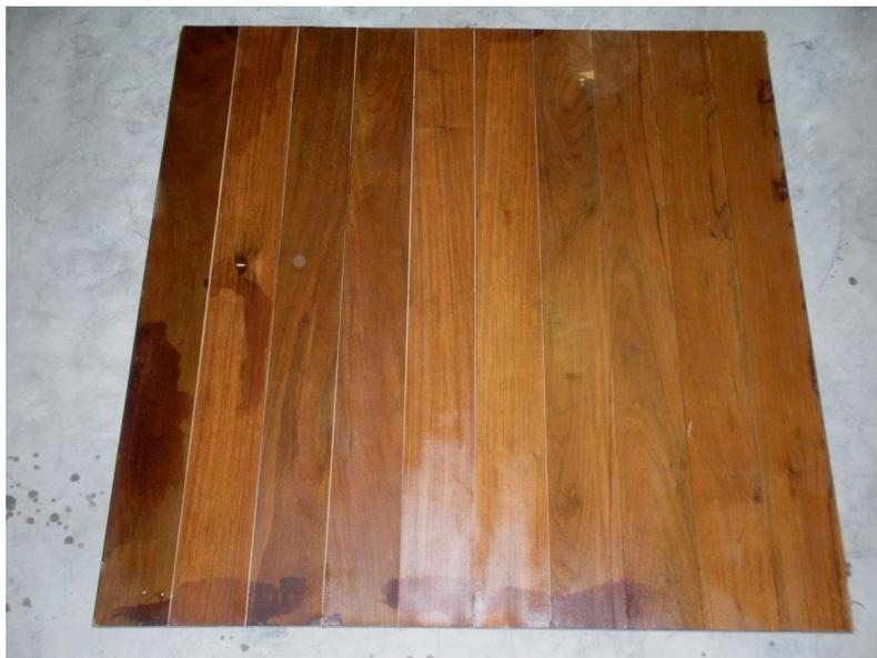
Figura 17 – Amostra de tábua corrida de Ipê ensaiada
