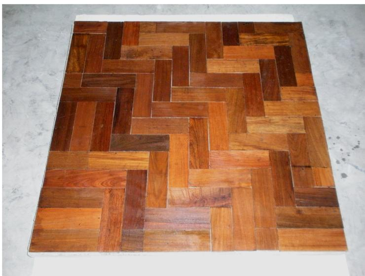
Figura 19 – Amostra de tacos de madeira ensaiada
