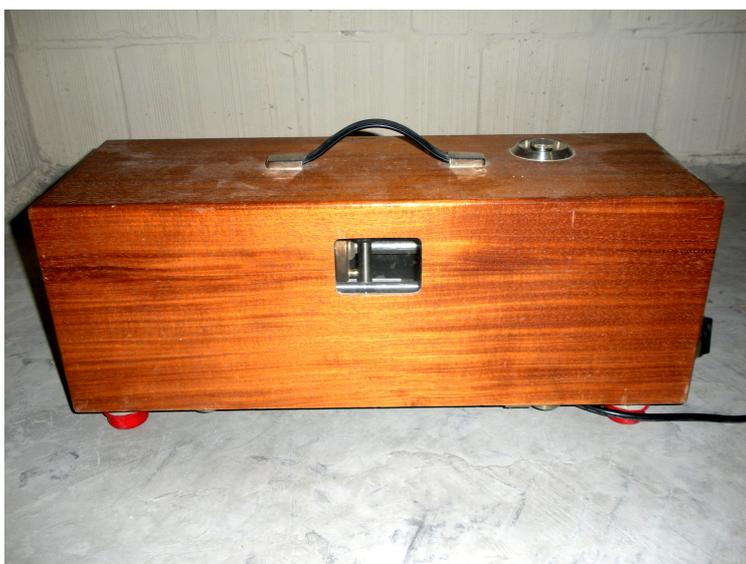
Figura 12 – Máquina geradora de ruído de impacto
