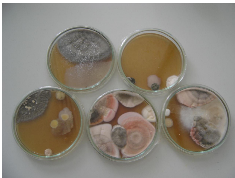
Figura 31- Cultura fúngica da película de tinta dos painéis tipo A.(Foto: Flayane H. Silva).
