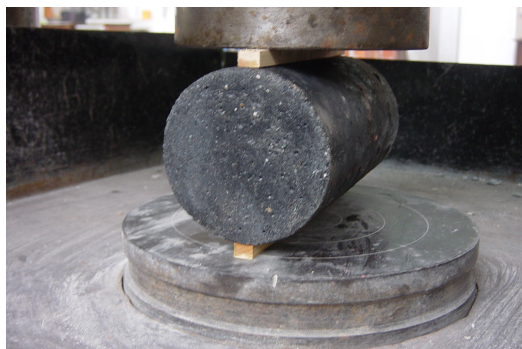
Figura 27: Posicionamento do cp para o ensaio de compressão diametral.
