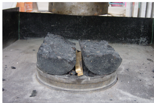
Figura 28: Cp rompido após ensaio de compressão diametral.
