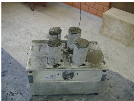
Figura 22: Adensamento dos corpos de prova em mesa vibratória.
