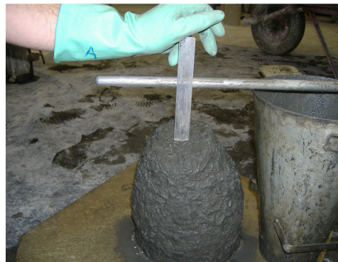
Figura 21: Abatimento do concreto.
