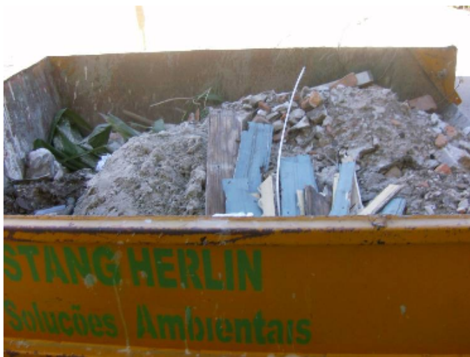
Figura 18 – Mistura de resíduos, contendo entulho, madeira, poda, entre outros. Março/2008
