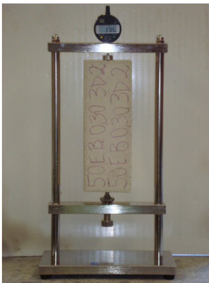
Figura 6.3 – Corpo-de-prova acoplado ao comparador de expansibilidade
