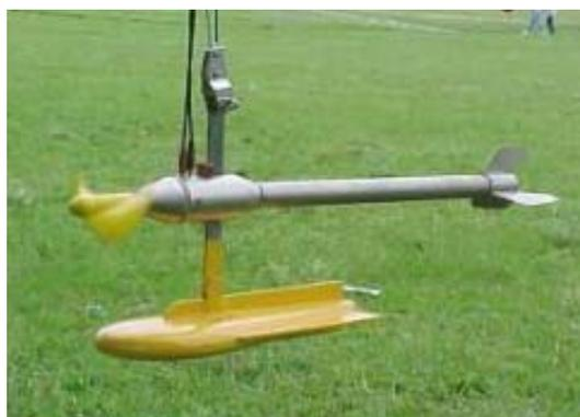
**Figura 3.5 - Molinete Fluviométrico Universal.**
