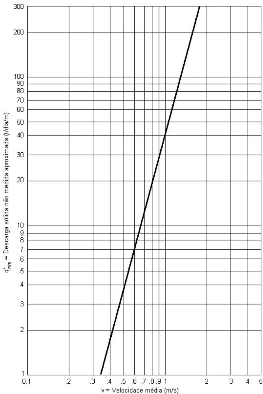
**Figura 2.8 - Ábaco para obtenção da descarga sólida não medida por metro de largura do rio a partir da velocidade média. Fonte: Paiva (2001).**
