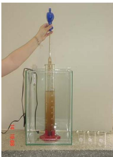
**Figura 3.13 - Ensaio de pipetagem**
