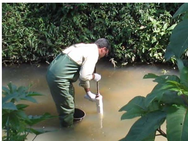
**Figura 3.10 - Amostrador US-BMH-53 modificado em operação.**
