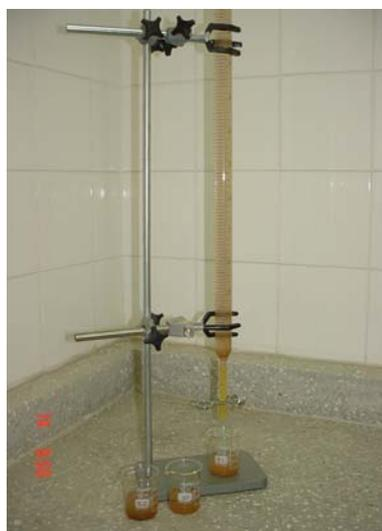
**Figura 3.12 - Ensaio do Tubo de Retirada pelo Fundo.**
