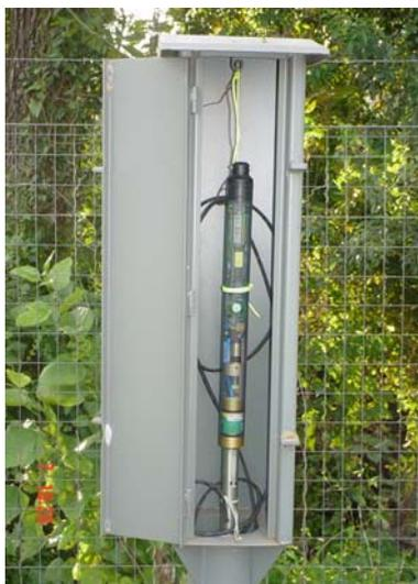
**Figura 3.4 - Limnígrafo eletrônico de pressão com datalogger.**
