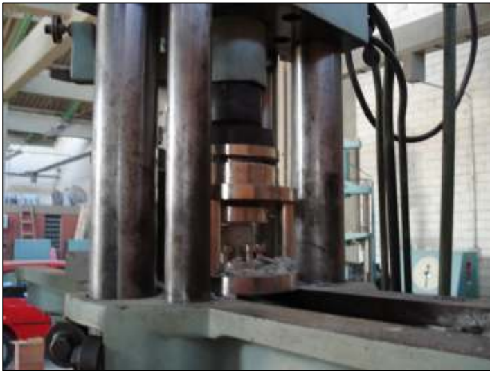
Figura 16 – Ensaio de resistência à compressão das argamassas
