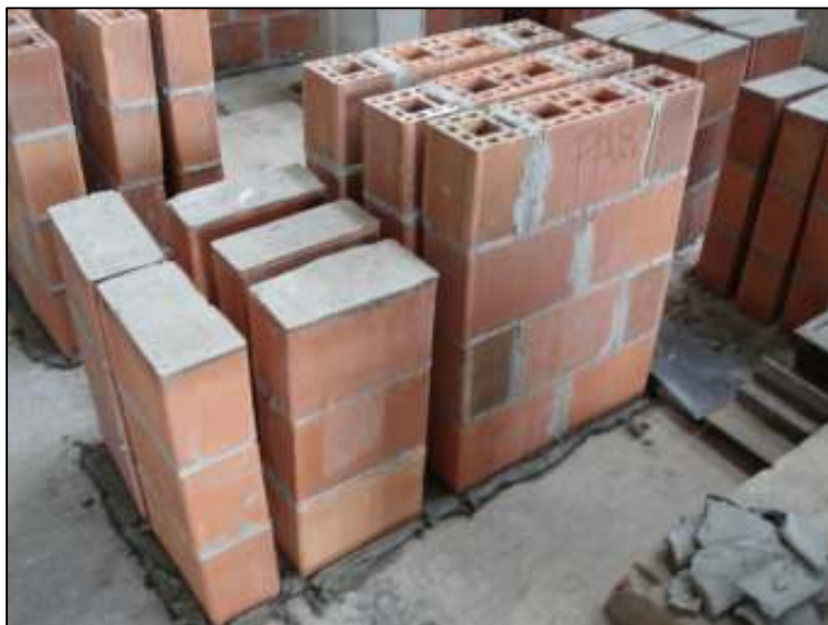
Figura 18 – Capeamento de prismas e pequenas paredes
