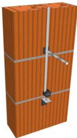
Figura 20 – Posição dos relógios medidores de deslocamentos nos prismas
