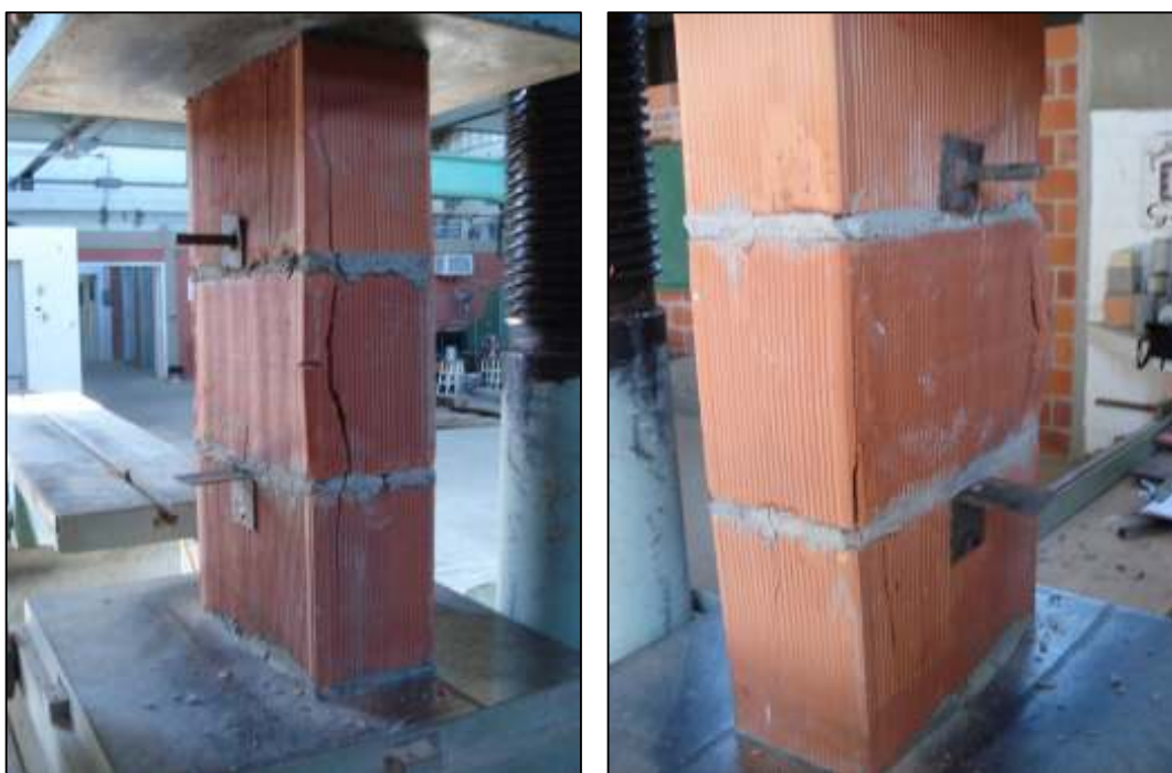
Figura 36 – Forma de ruptura dos prismas ensaiados.
