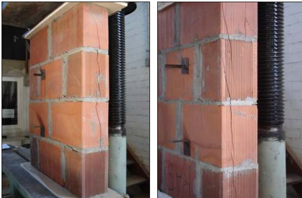
Figura 37 – Forma de ruptura das pequenas paredes ensaiadas.
