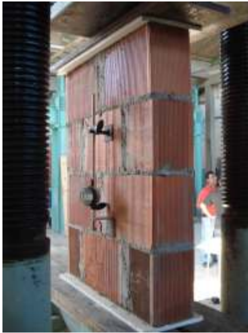
Figura 25 – Pequena parede com o relógio medidor de deformação fixado.
