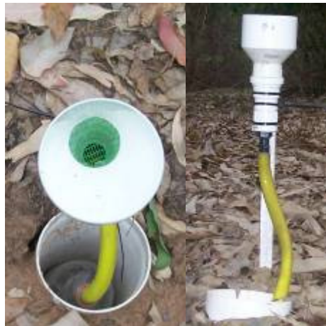
Figura 5.9 – Vista superior e lateral do interceptômetro.
