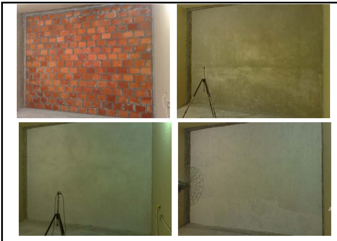
Figura 36 – Evolução da parede de acordo com os ensaios: parede em osso, revestimento na face externa, revestimento na face interna e textura na face externa.
