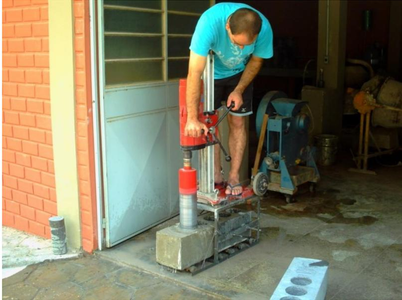
Figura 29 Extração mecanizada dos CPs.
