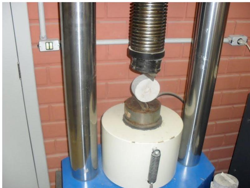
Figura 32 Preparação para o rompimento diametral.
