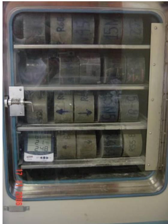
Figura 47 Câmara de carbonatação.
