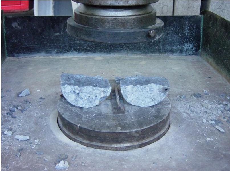
Figura 33 Rompimento diametral dos Corpos de Prova.
