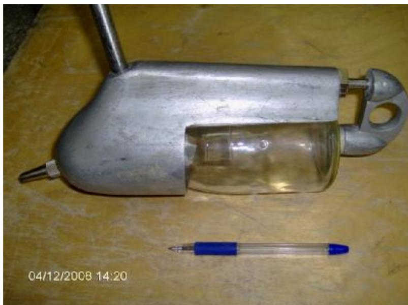
**Figura 15 – Amostrador de sedimentos em suspensão USDH – 48, marca Hidromec.**
