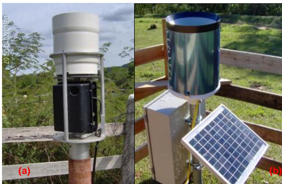
Figura 10- (a) Pluviógrafo de balança; (b) Pluviógrafo de báscula.
