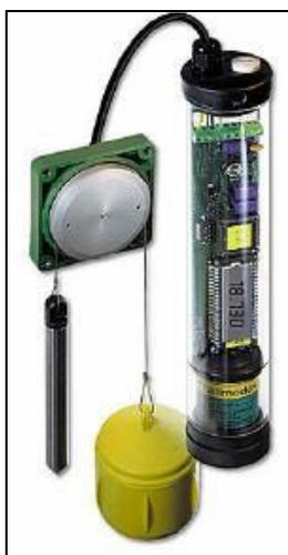
Figura 12 – Medidor eletrônico de nível Thalimedes.
