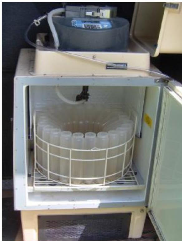
**Figura 14 – Amostrador de sedimentos em suspensão marca ISCO modelo FR760.**
