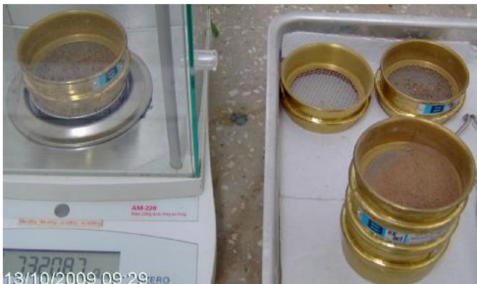
Figura 18 - Peneiras com material retido para determinação da granulometria do material.
