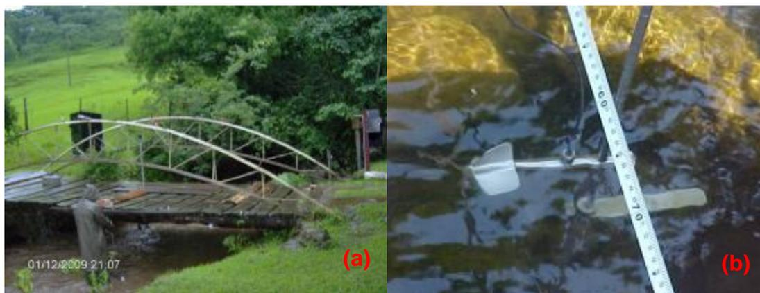
**Figura 13 – (a) - Medição de descarga líquida na estação fluviométrica Rancho do Amaral. (b) Micro-molinete Ott em medição.**
