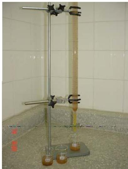
**Figura 17 - Tubo de retirada pela base.**
